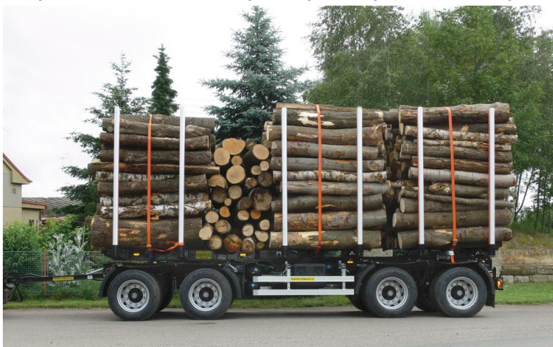
Obr. č. 21 Čtyřnápravový přívěs pro odvoz výřezů a rovnaného dříví Umikov PN 4.32 (foto Umikov)
