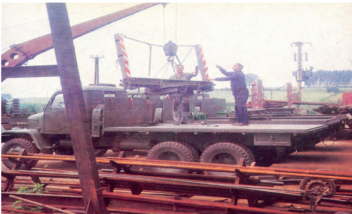
Obr. č. 8 - Úprava vozidla Praga V3S pro odvoz dříví (foto St. Švorc)
