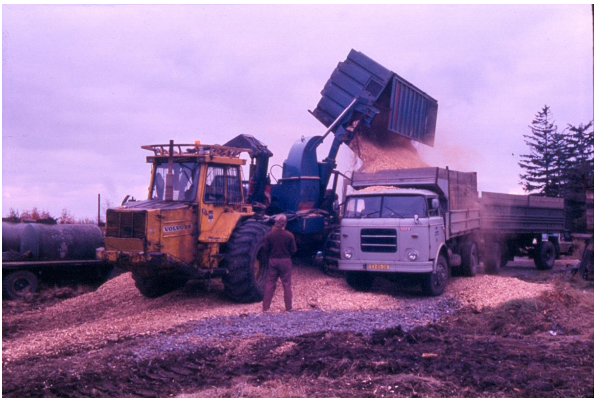
Obr.č.38 Nakládání štěpky na vozidlo Škoda Liaz 706 MTS štěpkovačem Bruks 1001 CT (foto W. Hetze)
