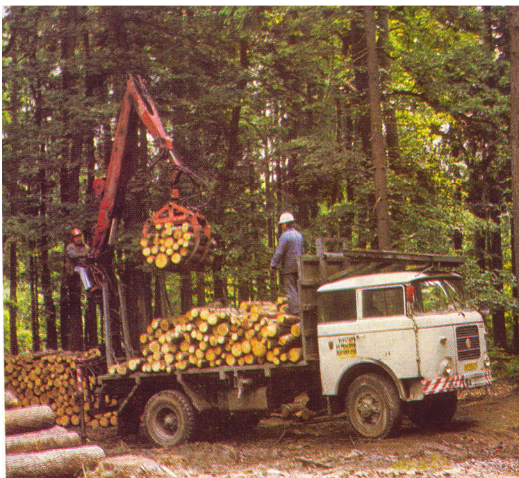
Obr.4 - Škoda 706 RTP s HR Hiab 560 a drapákem Hydra 07 RD při nakládce metrového rovnaného dříví
