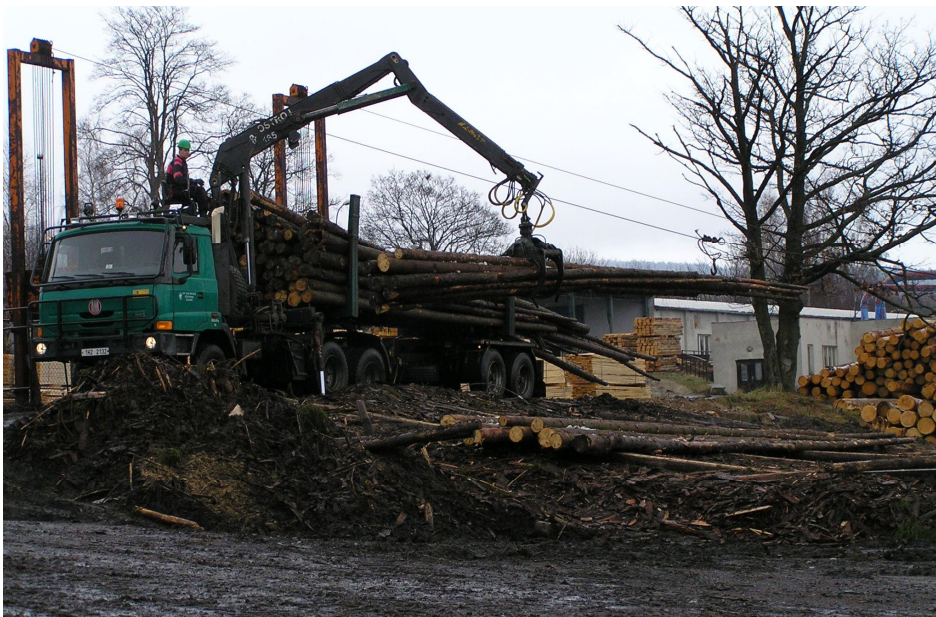
Obr. č. 42 Skládání dříví hydraulickou rukou Ostroj z vozidla Tatra 815.2 na manipulačním skladu LZ Kladská
