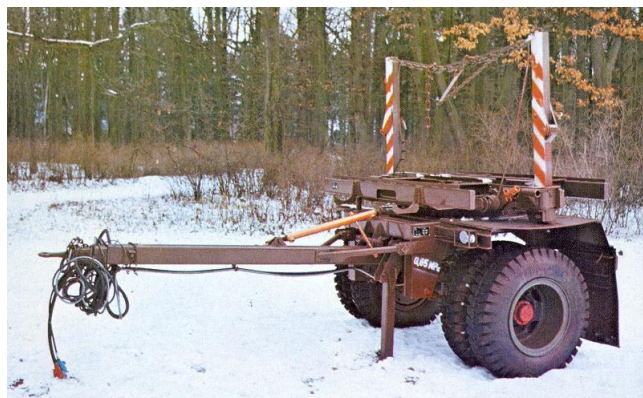
Obr. č. 22: Polopřívěs pro dovoz dlouhého dříví DAV – 8 (foto: SL PTR Olomouc)
