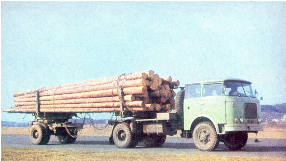
Obr. č. 7 - Š 706 vybavená pro odvoz dlouhého dříví dvojbubnovým navijákem ANN (foto St. Švorc)
