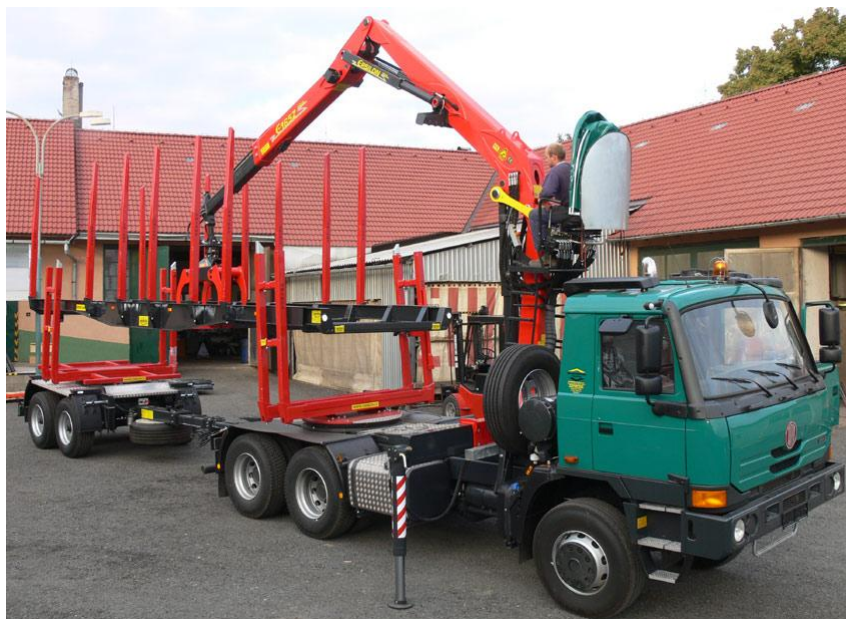
Obr. č. 20: Vkládání klanicové plošiny Umikov KP9 mezi opleny odvozní soupravy (foto Umikov)
