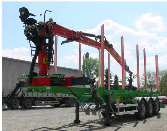
Obr. č. 15: Instalace HR na přední část návěsu (foto: Umikov)
