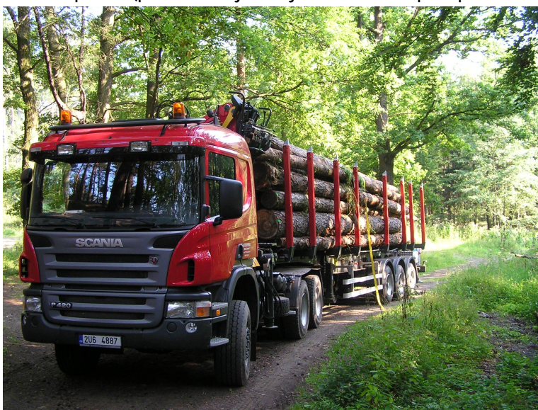
Obr. č. 23: Scania P420 6x6 HZZ s návěsem Umikov NPK 39
