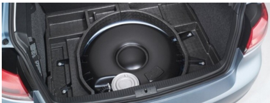
Obr. 5 Moderní uložení LPG nádrže ve vozidle (místo rezervního kola)
