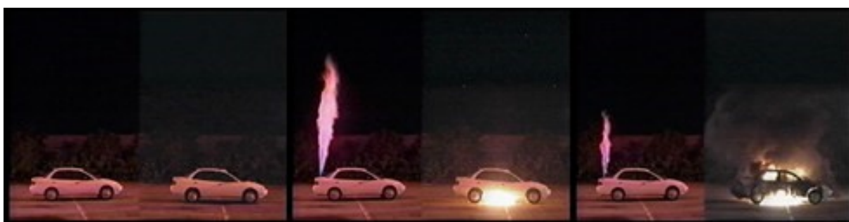
Obr. 17 Průběh vznícení vodíku (vlevo) a benzínu (vpravo)
