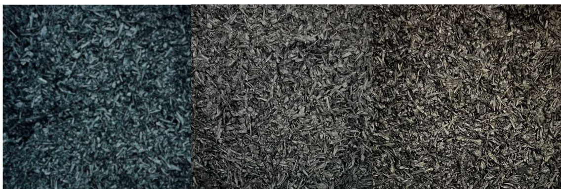
Obrázek 14 biouhel 350 °C, biouhel 450 °C, biouhel 550 °C (zleva) (autor)
