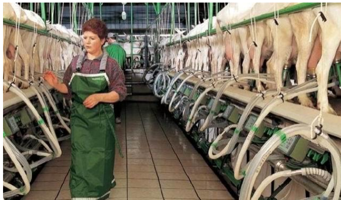
Obrázek č. 4: p Paralelní dojírna (Zdroj: Grasso (2012))
