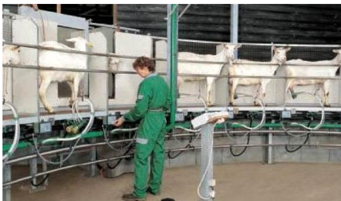
Obrázek č. 6: Rotační dojírna (Zdroj: Grasso (2012))
