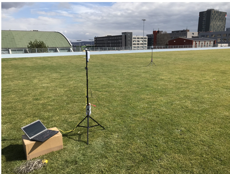
Obr. A.4: Měření vysílacího výkonu v závislosti na úhlu - horizontální
