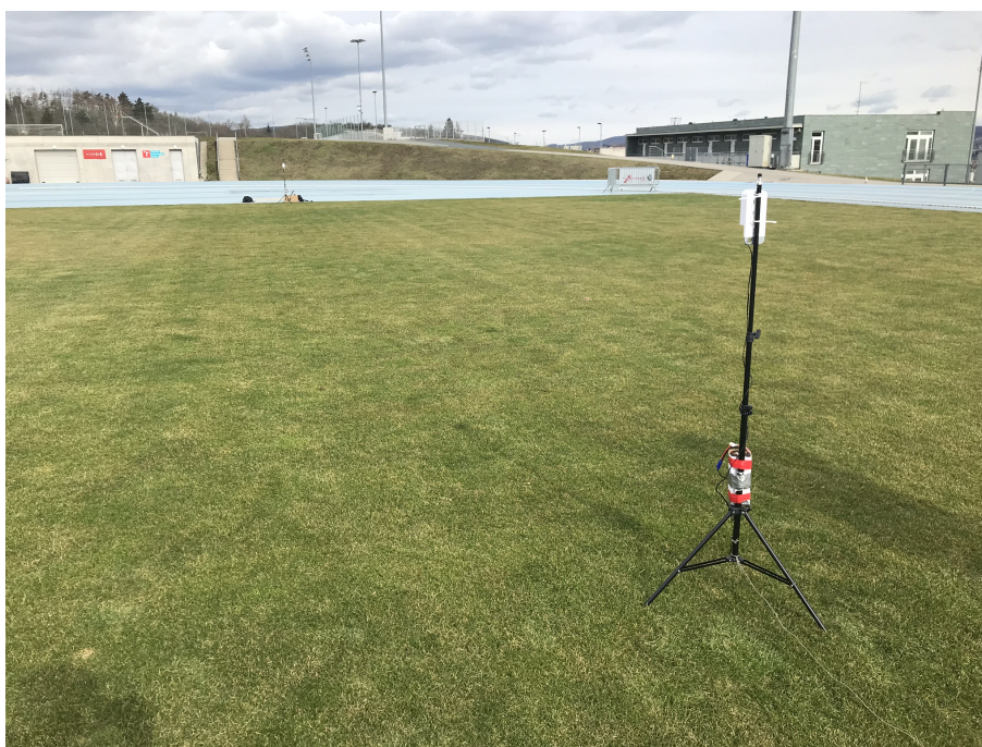
Obr. A.3: Měření vysílacího výkonu v závislosti na vzdálenosti
