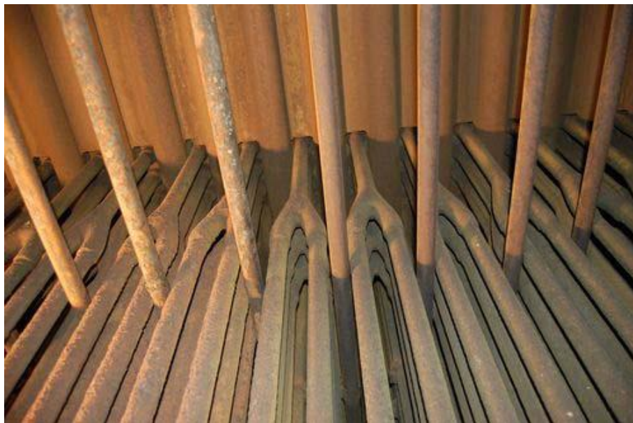
Obr. 6 Zoxidované trubky prehrievača P2, časti membránovej steny a závesov. [13]
