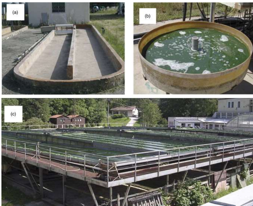
Obrázek 9 Otevřené kultivační systémy a) "Raceway" rybník s lopatkovým kolem 2500 l b) kruhový rybník s rotačním ramenem 100 l c) systém nakloněných ploch uspořádaných do kaskád (Třeboň) tři modely po 2200 l
