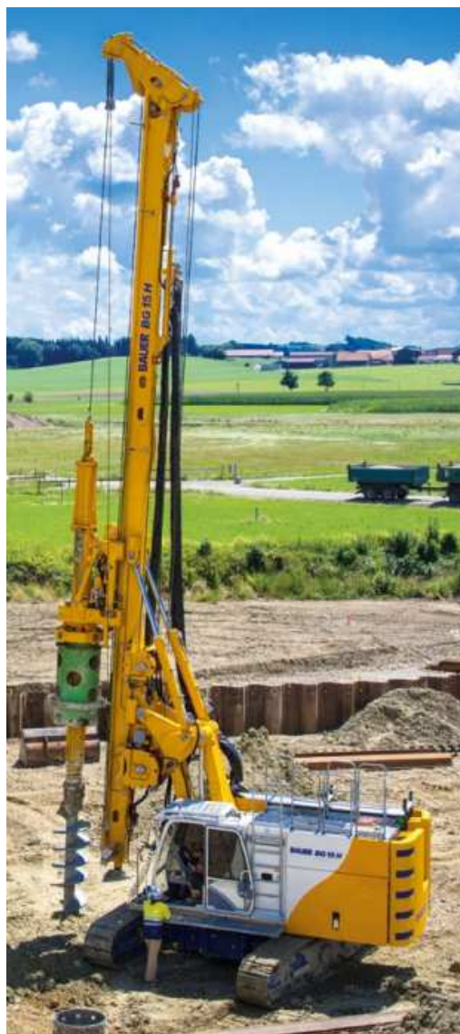
Obrázok E.18 – Pásová vrtná súprava BAUER BG 15 H s nástavcom KDK 150 SL [28]
