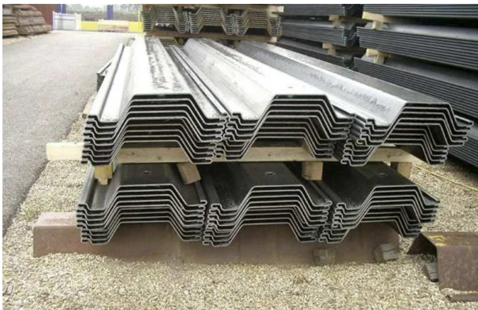
Obrázok F.2 – Znázornenie skladovania jednotlivých segmentov štetovnic [56]
