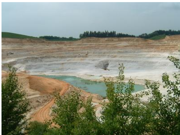
Obrázek 3: Povrchový lom ložisek sklářských písků ve Střelči
