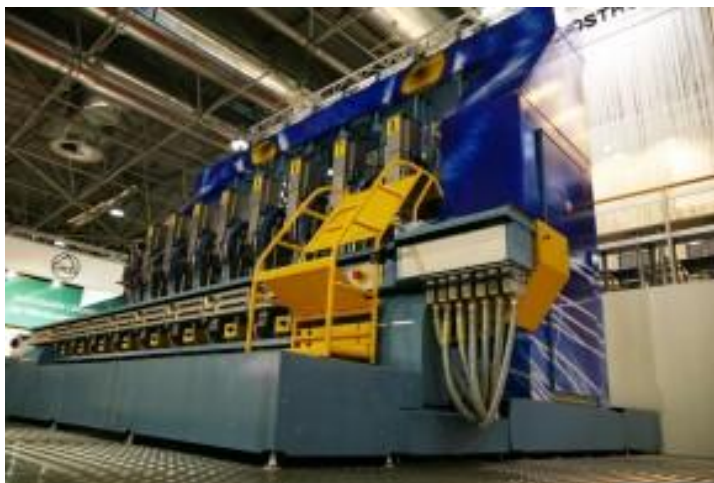
Obrázek 20: Prototyp nejnovějšího stroje na výrobu obalového skla – typ ISS
