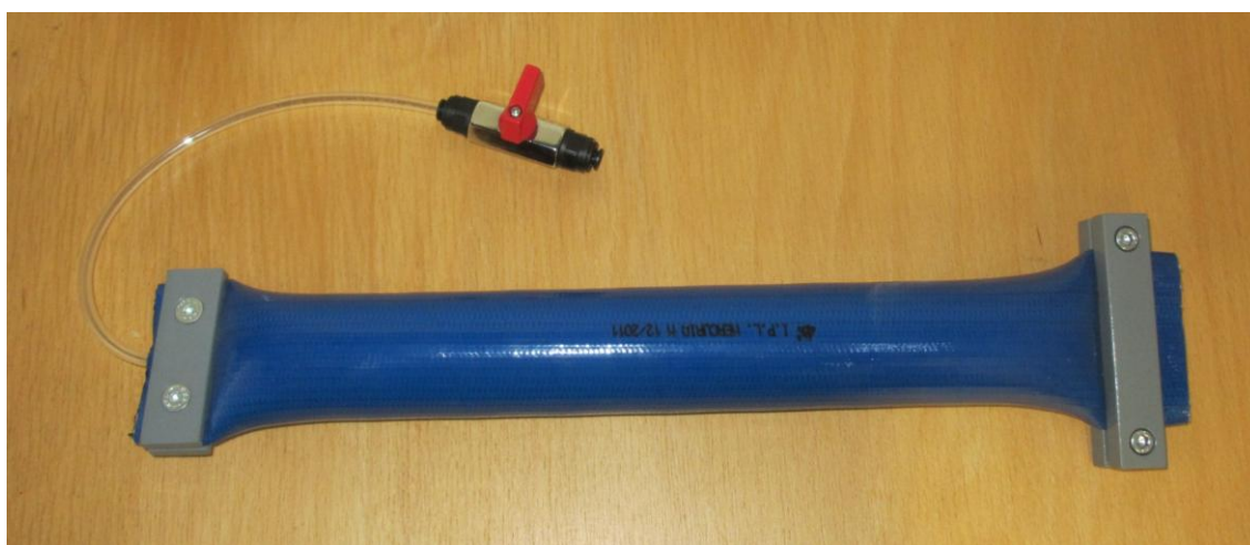
Obr. 19 Laboratorní hadicový autokláv pro vakuovo-tlakovou impregnaci vzorků plynným amoniakem. Základem je na plocho svinovatelná hadice MERCURIO M o průměru 45 mm.
