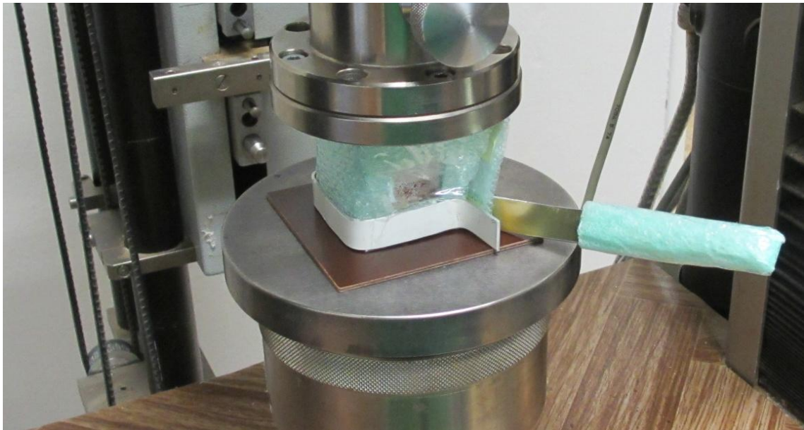
Obr. 17 Lisování vzorku plastifikovaného horkou párou ve zkušebním stroji Zwick Z050. Na fotografii je zachycen držák, který kromě přenášení vzorku s horkými hliníkovými bloky slouží také k vlhkostní a tepelné izolaci celého souboru.
