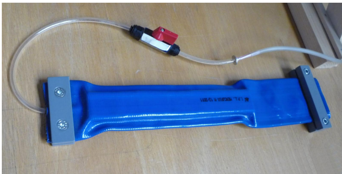
Obr. 23 Odsávání vzduchu z hadicového autoklávu
