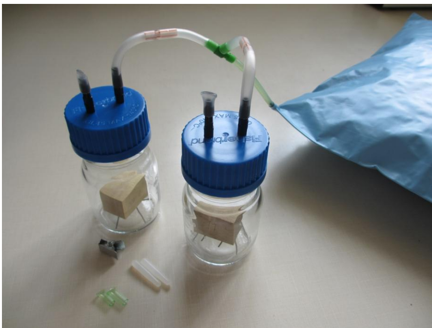
Obr. 11 Detail sestavy na impregnaci dvou vzorků plynným amoniakem
