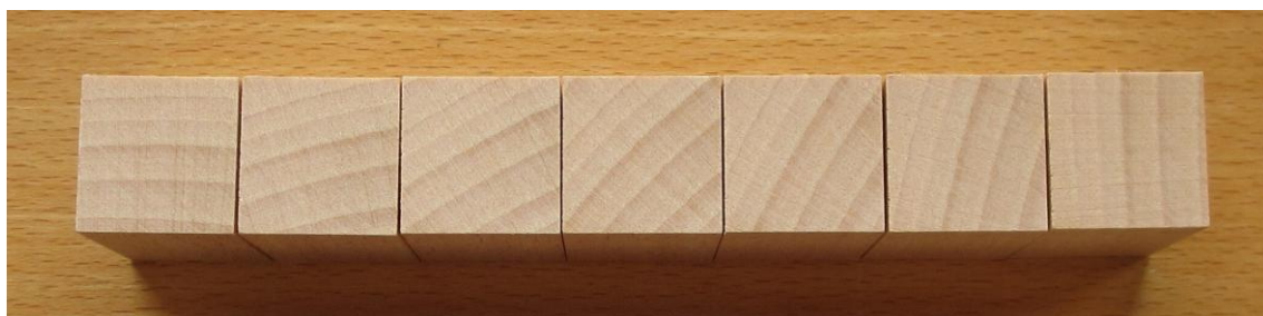
Obr. 8 Zhotovená sada zkušebních vzorků s různým odklonem letokruhů
