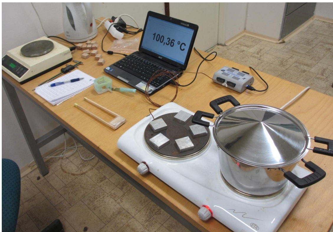
Obr. 16 Pracoviště pro plastifikaci vzorků horkou párou, měření a vážení vzorků, ohřev hliníkových bloků a přípravu souboru pro měření ve zkušebním stroji Zwick Z050
