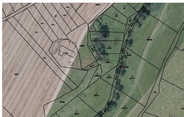
Obr. 103: ZSV Husí. Umístění a orientace zaniklého kostela. Po obvodu parcely jsou zřetelné zbytky hřbitovní zdi zachycené na geofyzikálním měření (zpracoval: V. Kolomazníček).
