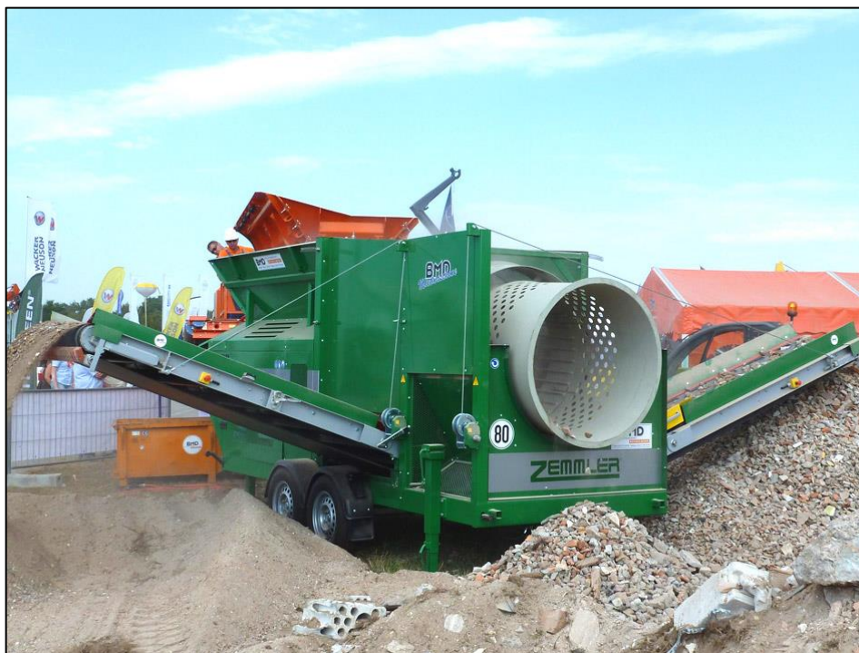
Obrázek 8: Válcový (bubnový) tříděč při práci [61]
