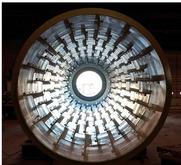
Obr. 2 Vnitřní lopatková vestavba rotačního válce [5]
