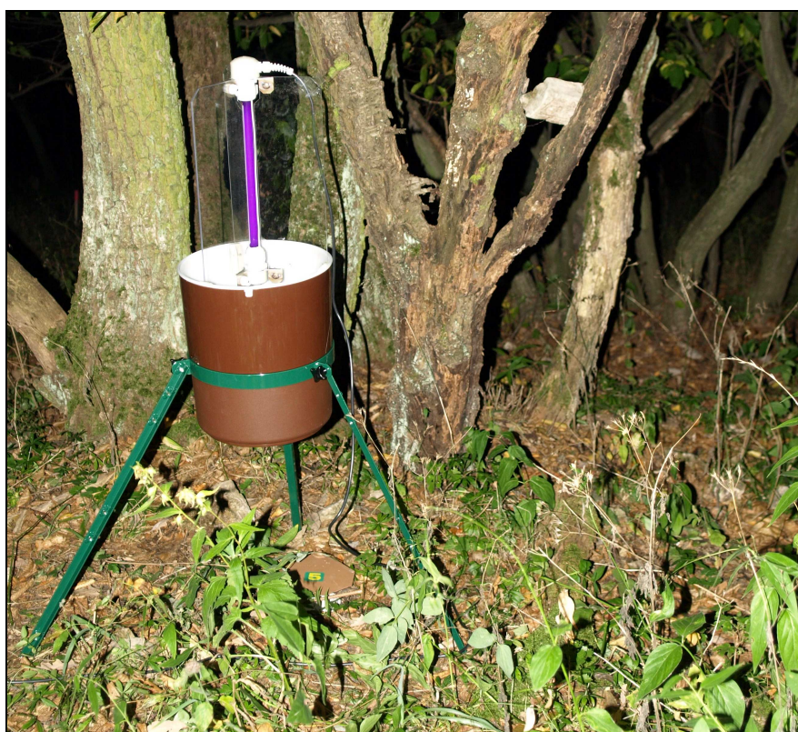
Obrázek 4. Přenosný světelný lapač typu Minnesota resp. její modifikace s lineárním zářivkovým tělesem, tzv. Pennsylvánský lapák, určený pro monitoring v noci aktivních motýlů.
