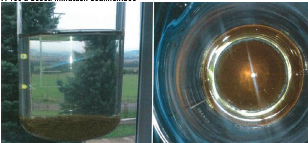
Foto č. 4 Koagulant síran železitý po aplikaci finální dávky 200 g/m 3 + 4 g/m 3 polymeru A-100 a deseti minutách sedimentace
