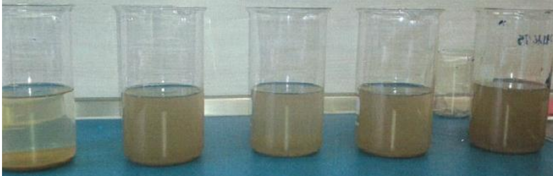
Foto č. 2 Koagulanty po aplikaci finální dávky 200 g/m 3 a deseti minutách sedimentace
