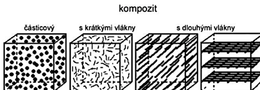
Obr. 2.1 Dělení kompozitních materiálů dle uspořádání výztuže (Kratochvíl a kol. 2005).
