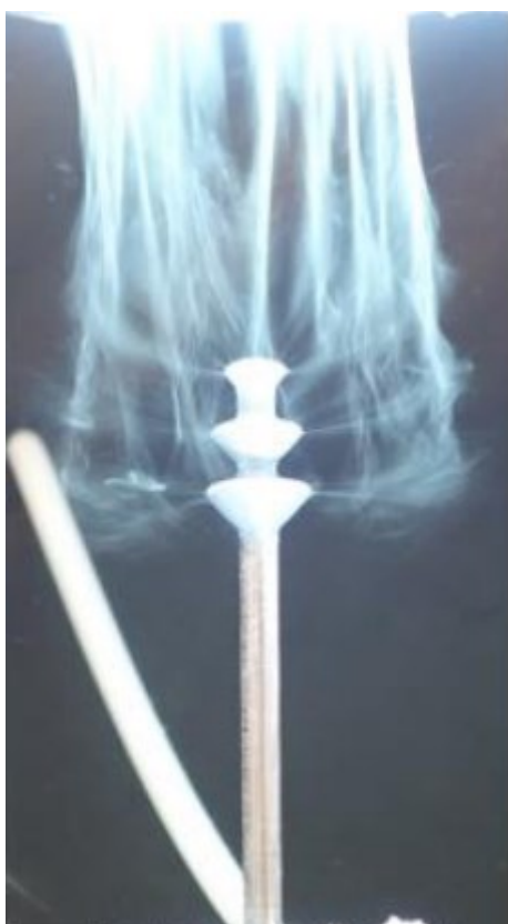
Obrázek 9 Vícestupňová jádrová elektroda vyrábějící nanovláknna., převzato z [11]
