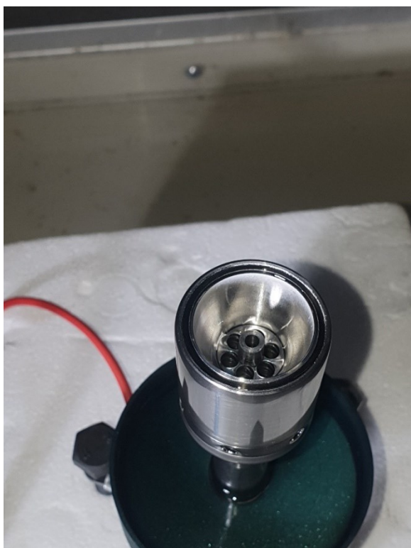
Obrázek 22 Zanášení vnitřního nepřeplaveného prostoru parazitními nanovláknky
