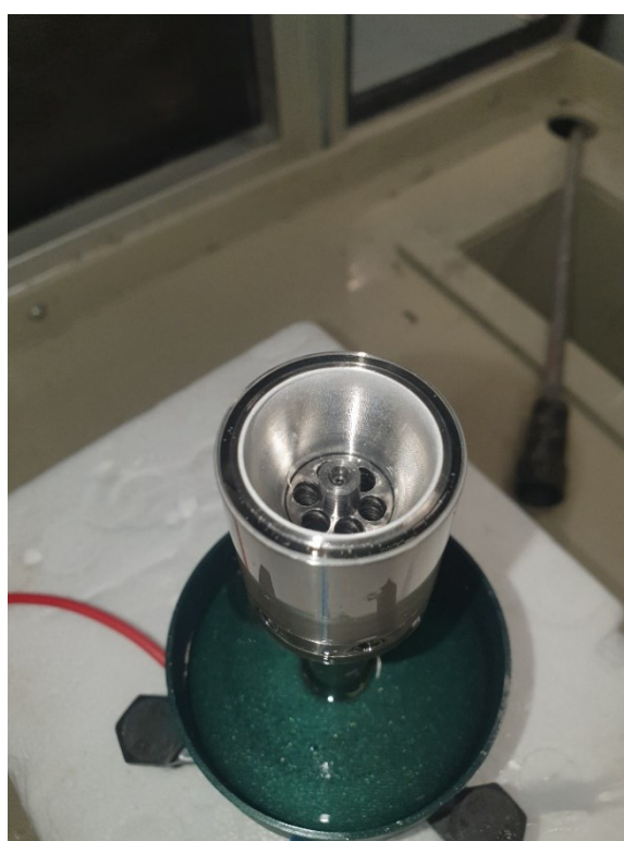
Obrázek 22 Zanášení vnitřního nepřeplaveného prostoru parazitními nanovláknky
