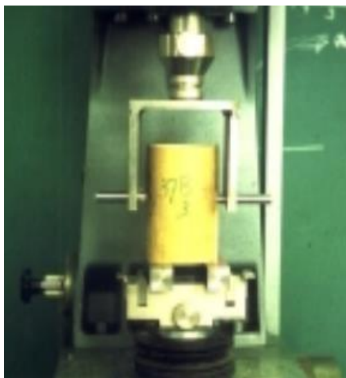
Obr. 6: Zkouška pevnosti v tahu – testování pomocí navrtaného šroubu (Janssen 2000)
