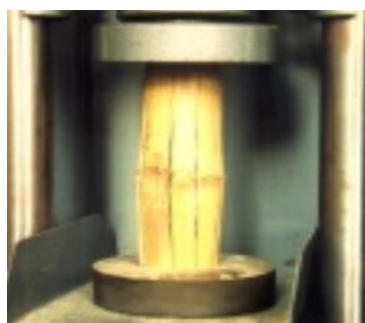
Obr. 4: Zkouška pevnosti v tlaku – osa působení síly rovnoběžná se směrem vláken (Janssen 2000)
