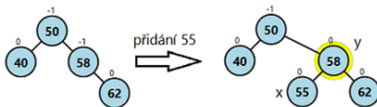
Obrázek 8: Příklad Přidání uzlu do AVL stromu, kde b = 0
