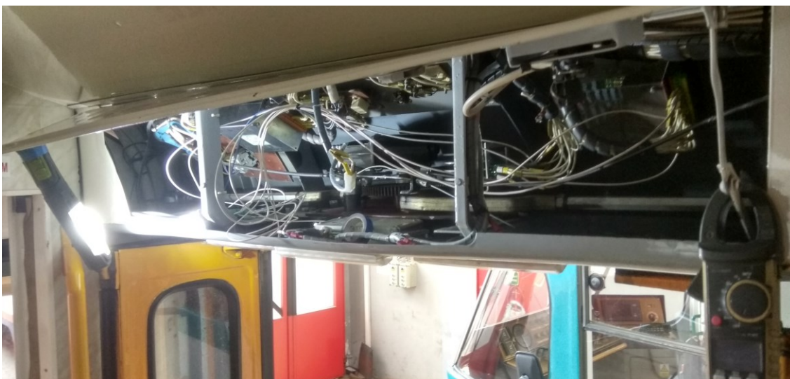
Obr. 25: Prostor strojovny předních dveří tramvaje
