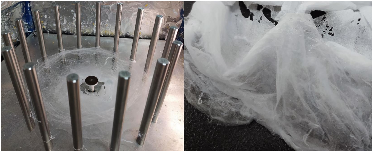
Obrázek 20 Zvlákňování roztoku o obsahu 4 hm. % PHB metodou odstředivého zvlákňování: ulpělá vlákna tyčích kolektoru (vlevo), získaný produkt po zvlákňování 10 ml roztoku (vpravo)
