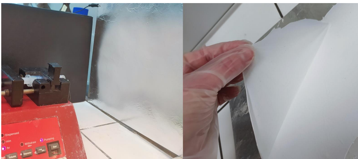
Obrázek 19 Zvlákňování roztoku o obsahu 2 hm. % PHB metodou elektrostatického zvlákňování: průběh zvlákňování (vlevo), snímání nanovlákněného produktu po zvlákňování 10 ml roztoku (vpravo)
