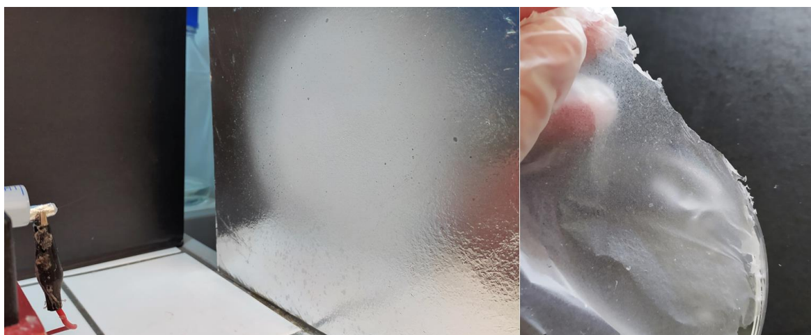
Obrázek 26 Tvorba krytu na bázi PHB s integrovanými liposomovými částicemi metodou emulzního elektrostatického zvláknění (vlevo), získaný PHB kryt s liposomy (vpravo)
