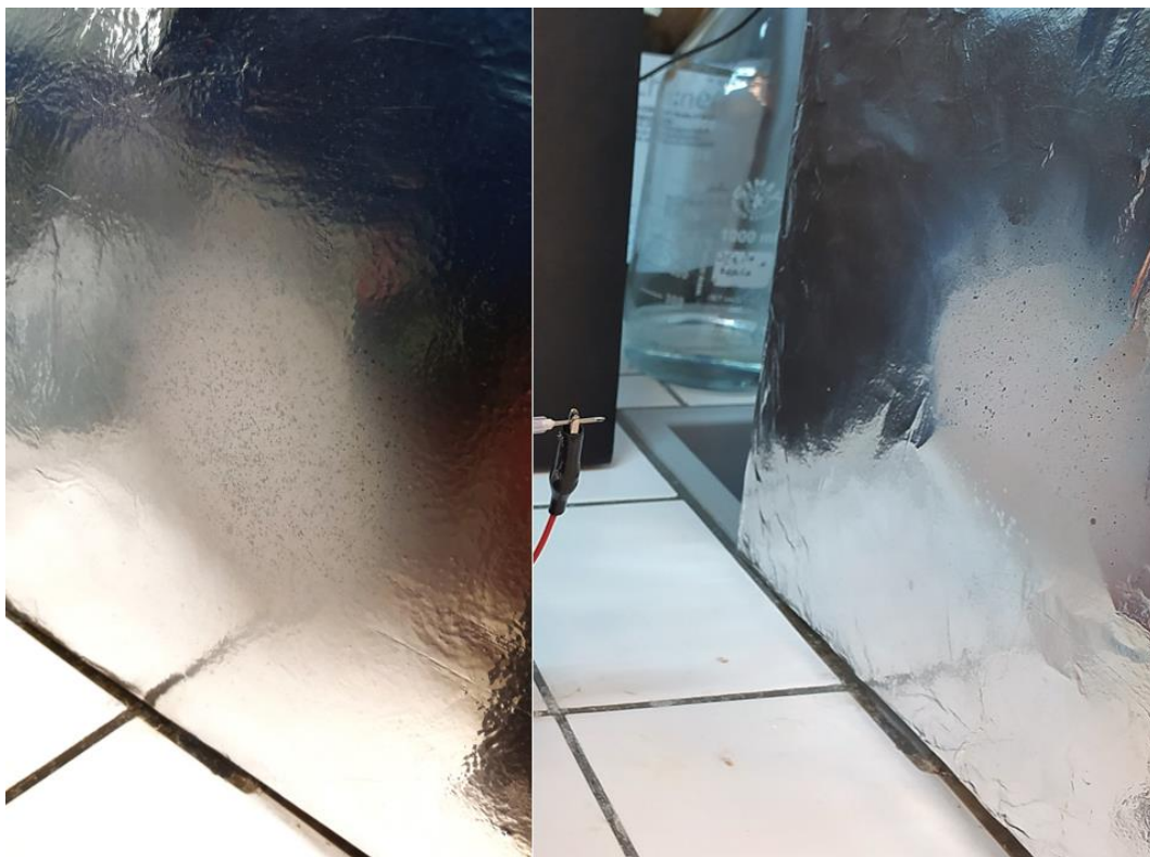
Obrázek 18 Produkty z roztoku o obsahu 4 hm. % SA/PEO (poměr polymerů 1 : 1) s obsahem 0,5 hm. % Tritonu X-100 (vlevo) a z roztoku o obsahu 5 hm. % SA/PEO s přidavkem 0,5 hm. % Tritonu X-100 a 5 hm. % DMSO (vpravo)
