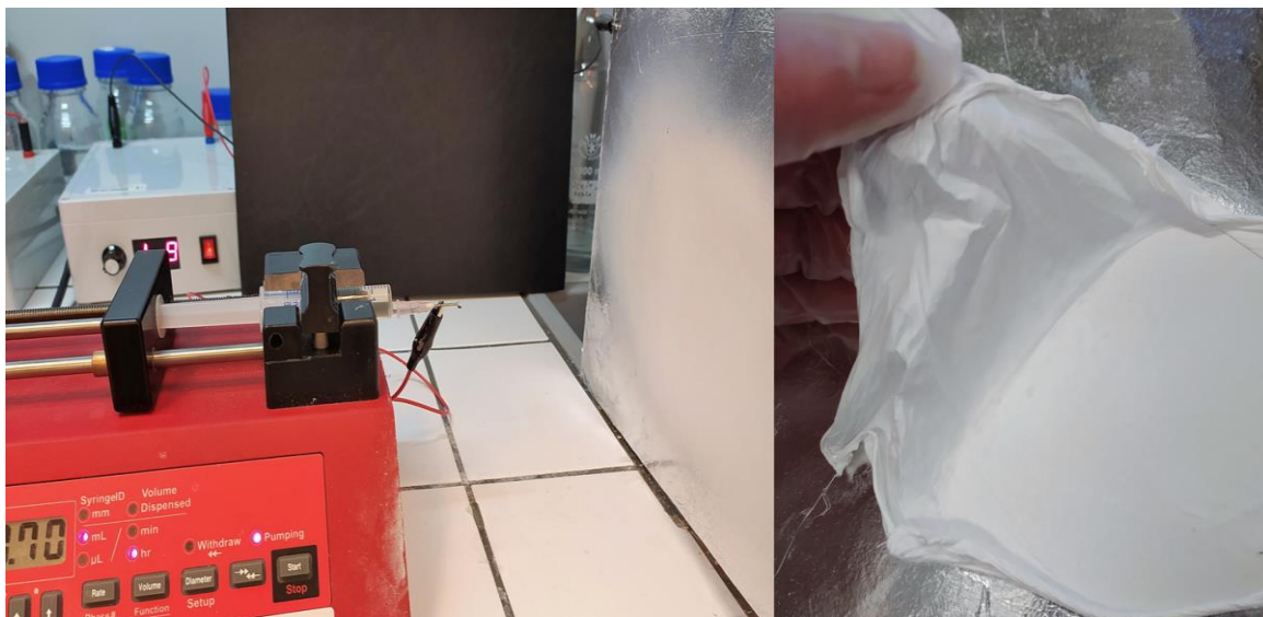
Obrázek 21 Zvlákňování želatinového roztoku (25 hm. % želatiny) metodou elektrostatického zvlákňování: průběh zvlákňování (vlevo), získávání produktu po zvlákňení 2,5 ml roztoku (vpravo)
