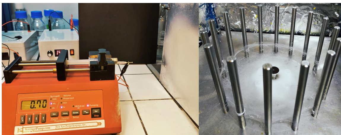
Obrázek 8 Zvláknovací zařízení: elektrospinnová soustava (vlevo), zařízení pro odstředivé zvláknování (vpravo)
