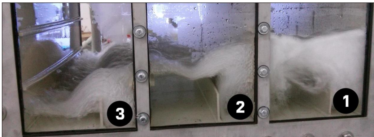
obr. 56: Pěnění slané vody v průběhu experimentu v prototypu MSF odparky.
