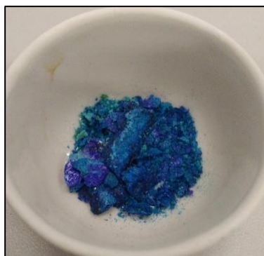
obr. 63: Produkt krystalizace destilátu s vysokým podílem skalice modré.
