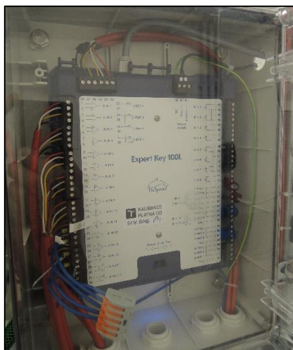
obr. 44: Měřicí karta Delphin Expert Key 100L použitá při sběru dat.
