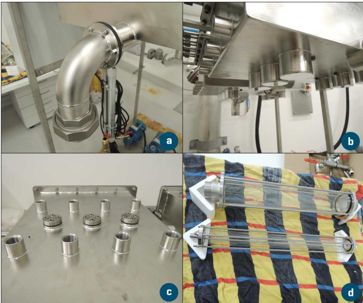
obr. 41: Některé z realizovaných konstrukčních úprav: rozšíření odvodních hrdel (a), rozšíření přechodových kanálků a návarky pro teploměry (b), návarky pro vakuometry a jiná měřidla (c), transparentní odtoková potrubí (d).
