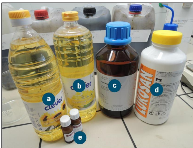
obr. 36: Testované protipěnicí přípravky: Slunečnicový olej (a), řepkový olej (b), kyselina olejová (c), Lukosan P2 (d) a Erbslöh Schaum-ex (e).
