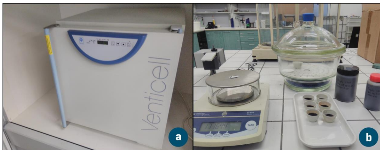
obr. 34: Pomůcky pro měření obsahu sušiny ve fugátu: sušárna Venticell 55 Standard (a), keramické misky, skleněný exsikátor a analytická váha (b).
