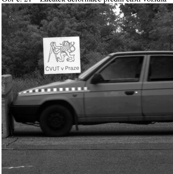
Obr č. 21 – Začátek deformace přední části vozidla
