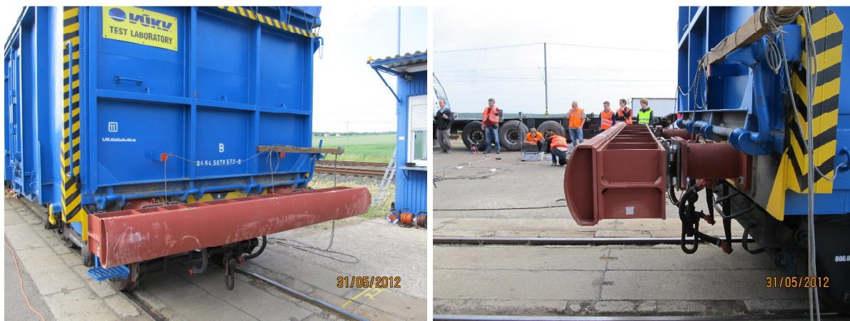
Obr. č. 30 – Impaktor o vysoké tuhosti použitý při první nárazové zkoušce
