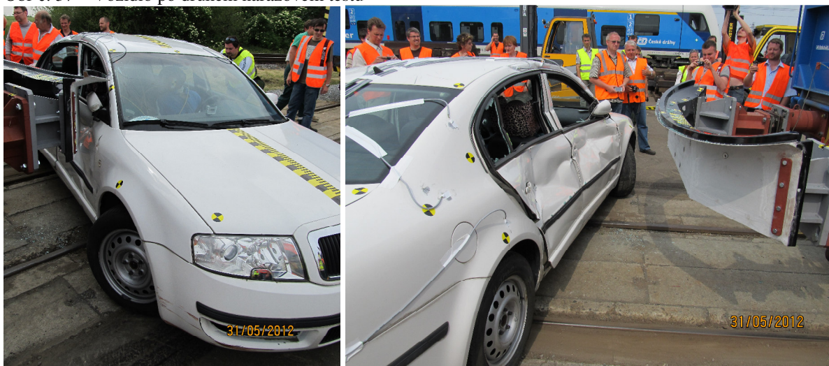
Obr. č. 37 – Vozidlo po druhém nárazovém testu
