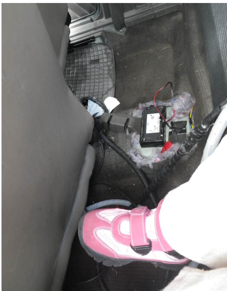
Obr. č. 18 – Umístění jednotky eCall v při nárazových testech
