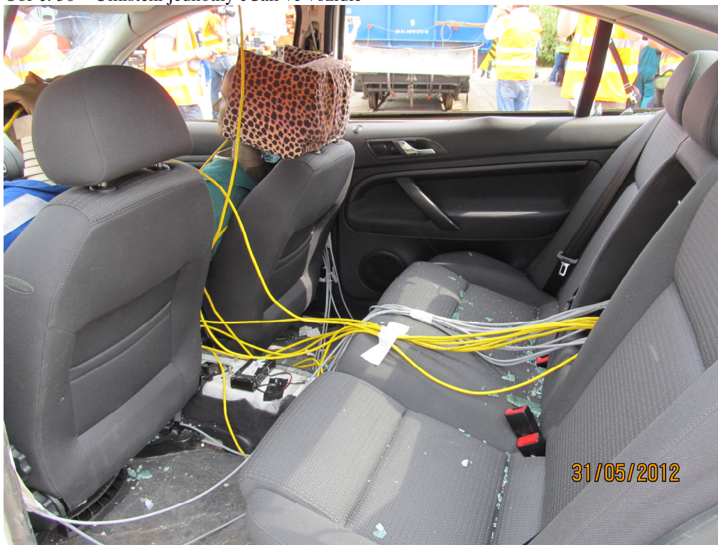
Obr. č. 36 – Umístění jednotky eCall ve vozidle
