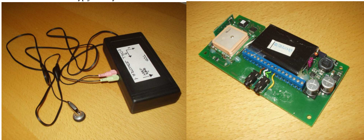
Obr. č. 16 a 17 – Prototyp jednotky eCall
