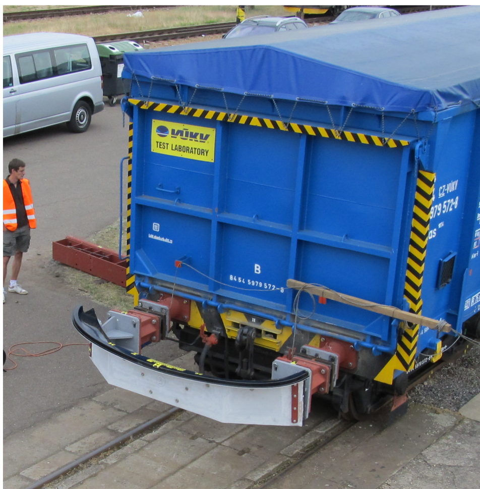
Obr. č. 31 – Tramvajový čelník použitý při druhé nárazové zkoušce
