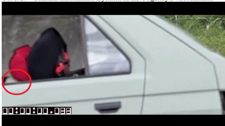
Obr. č. 27 – Okamžik maximálního zrychlení na hlavě figuríny z videozáznamu
