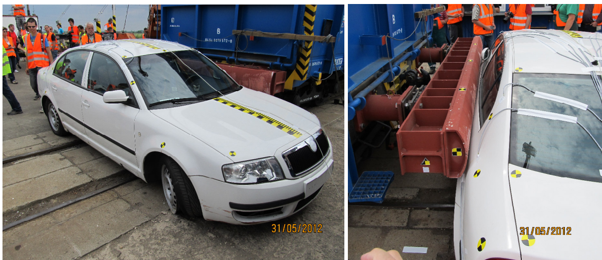
Obr. č. 32 – Vozidlo po prvním nárazovém testu
