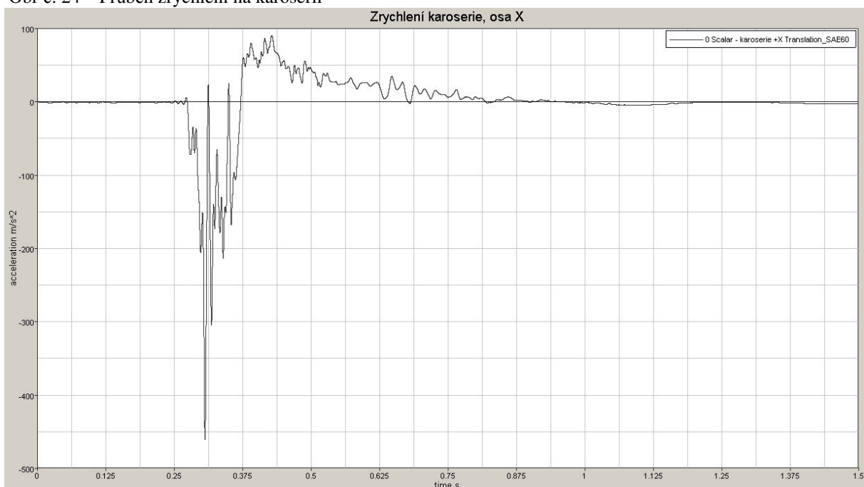
Obr. č. 24 – Průběh zrychlení na karoserii
