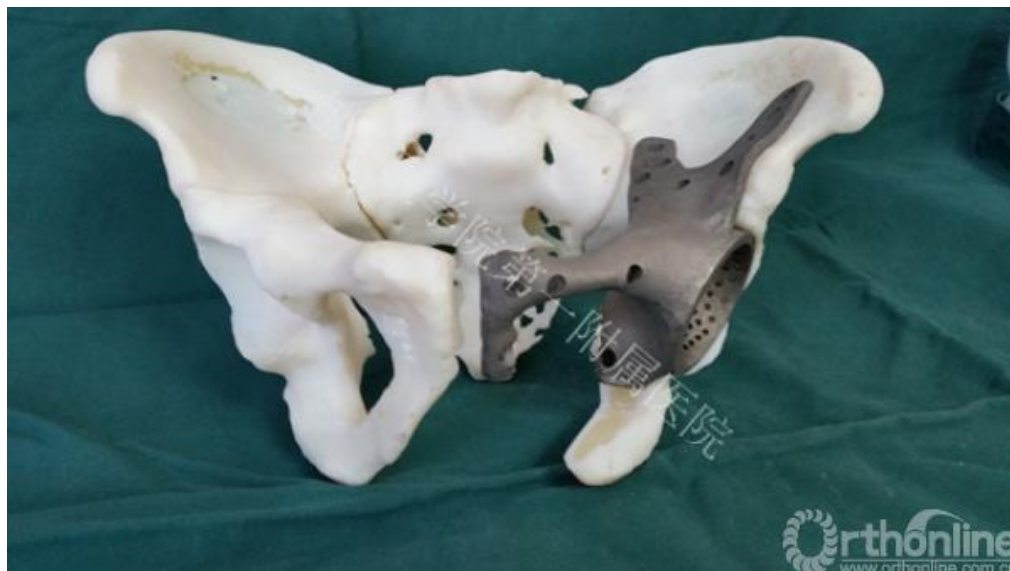
Obrázek 8: implantát pánevní kosti vyrobený pomocí 3D technologie
