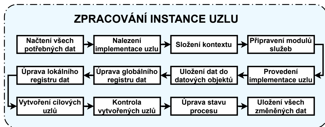
Obrázek 5.3: Řetězec zpracování instance uzlu běhovým jádrem procesu, jenž znázorňuje všechny etapy, kterými při zpracování instance uzlu projde. (Diagram byl vytvořen za využití nástroje draw.net.)
