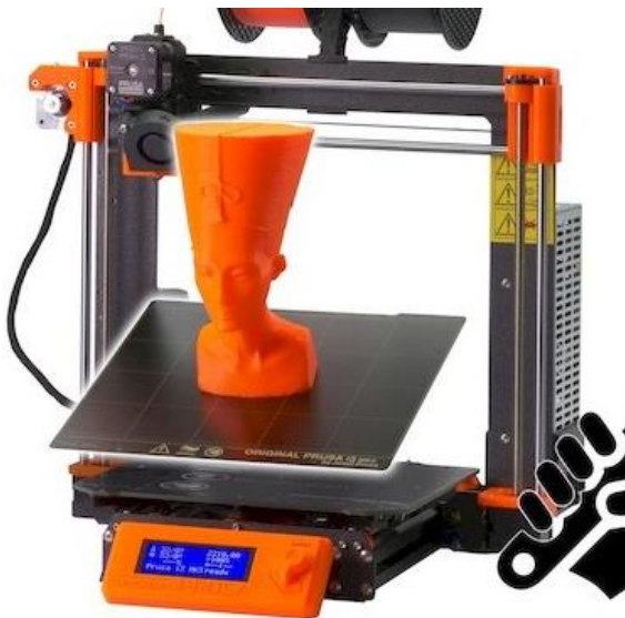
Obrázek 51 – Tiskárna s pohybem stolu v ose Y. Zdroj: [45].
