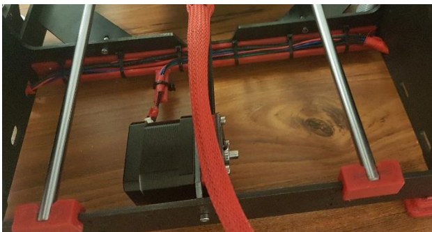
Obrázek 116 – Žlab na kabely pod osou Y. Zdroj: vlastní
