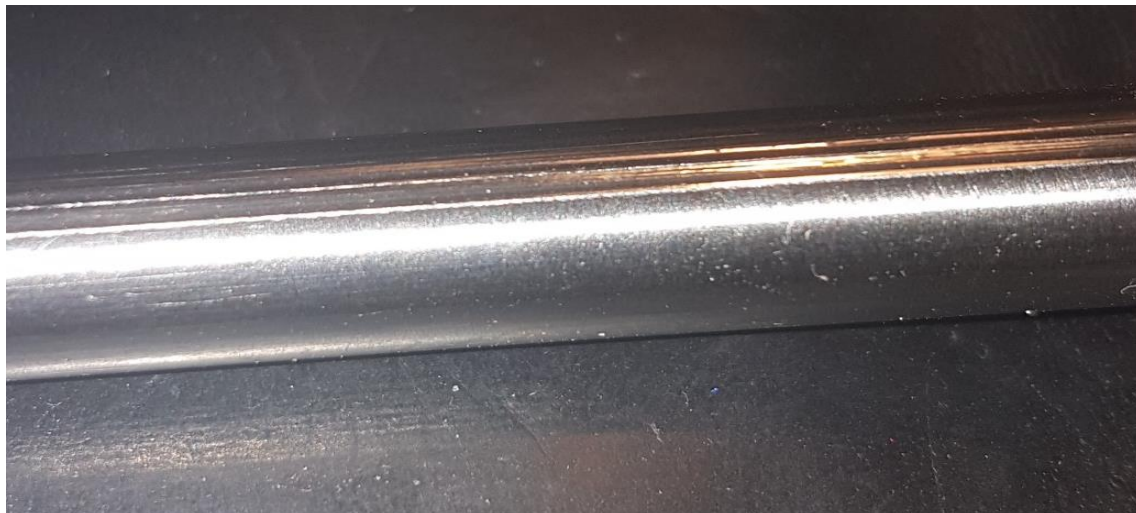
Obrázek 89 – Poškozená vodící tyč od kuliček lineárního ložiska. Zdroj: vlastní.
