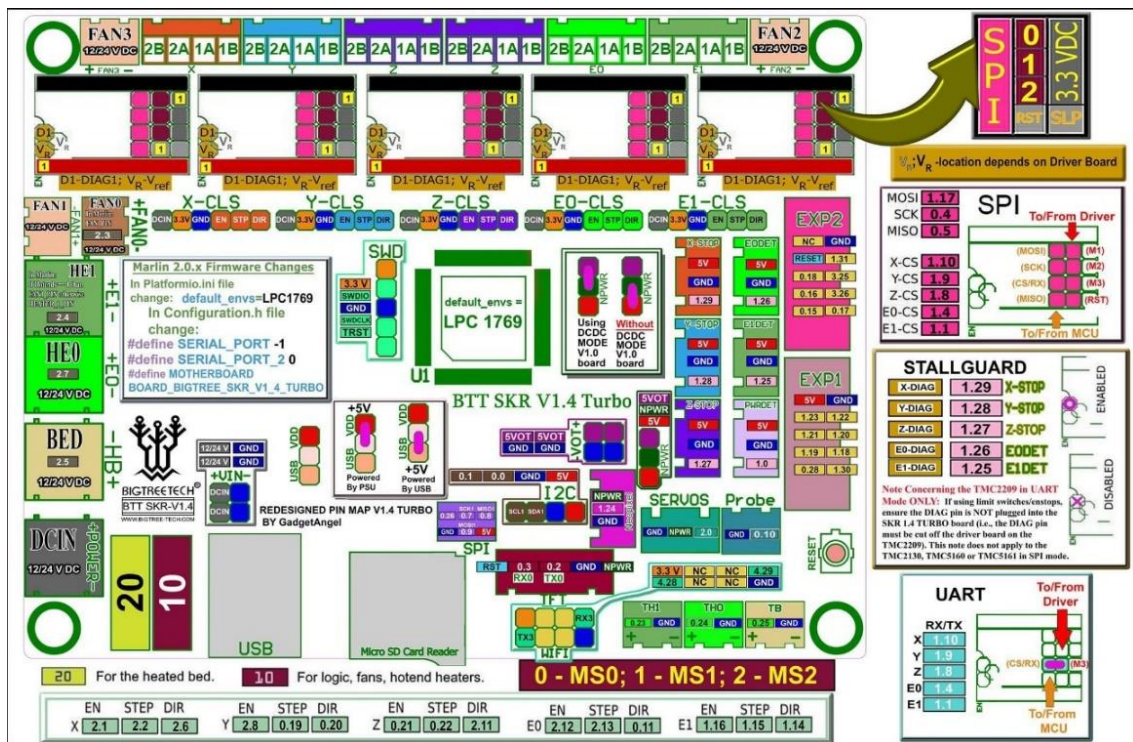
Obrázek 110 – Řídicí jednotka Bigtreetech SKR 1.4 Turbo. Zdroj [88].
