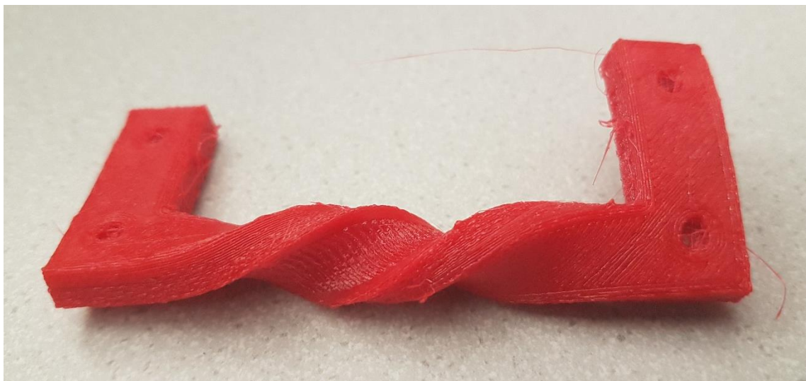
Obrázek 123 – Přehřátý díl, ručně zdeformováno, rozměry 80 x 34 x 6 mm. Zdroj: vlastní.
