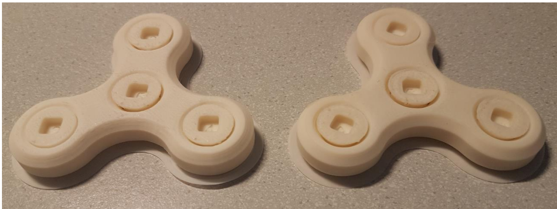
Obrázek 131 – Identické tisky materiálem ABS. Zdroj: vlastní.
