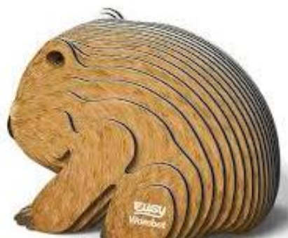
Obrázek 29 – Model zvířete vytvořený metodou 3d tisku LOM. Zdroj: [24].
