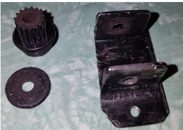
Obrázek 96 – Již opravovaná kladka osy X. Zdroj: vlastní.
