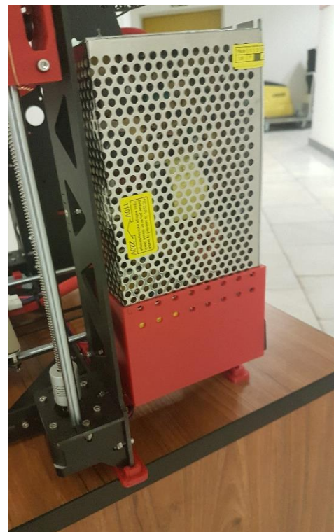
Obrázek 117 – Napájecí zdroj. Zdroj: vlastní.
