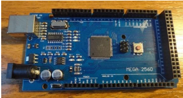
Obrázek 34 – Arduino MEGA2560. Zdroj: vlastní.
