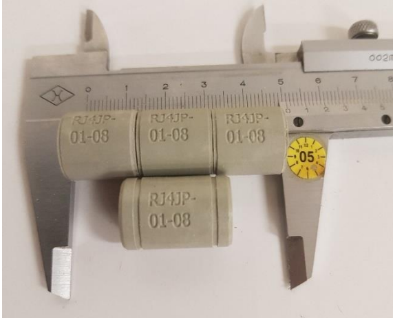
Obrázek 93 – Upravená polymerová lineární ložiska. Zdroj: vlastní.
