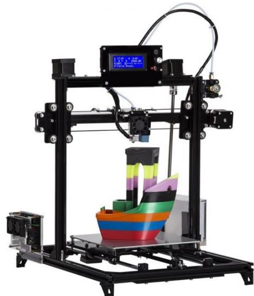
Obrázek 52 – Tiskárna s pohybem stolu v ose Y. Zdroj: [46].
