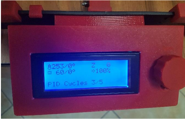
Obrázek 113 – LCD s informací o probíhající PID kalibraci. Zdroj: vlastní.
