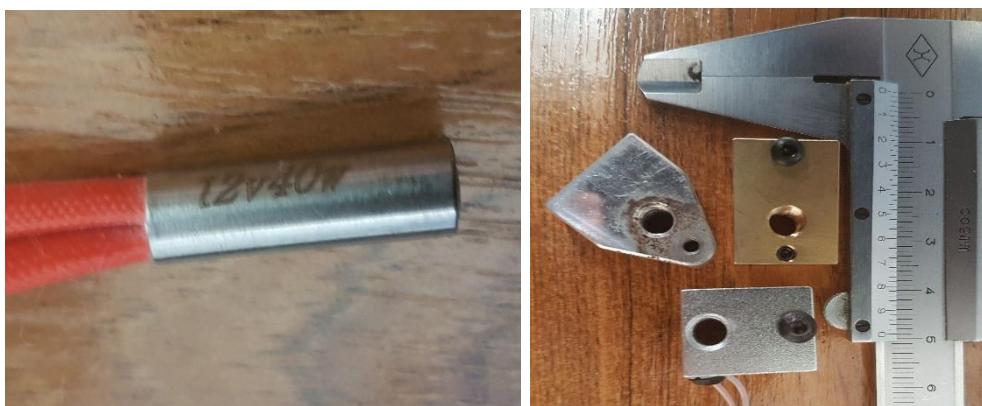
Obrázek 88 – topné těleso vlevo, 3 typy vyhřívacích bloků vpravo. Zdroj: vlastní.
