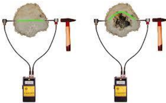
Obr. 1: Ukázka šíření zvuku ve dřevě s vadou a ve dřevě zdravém.
