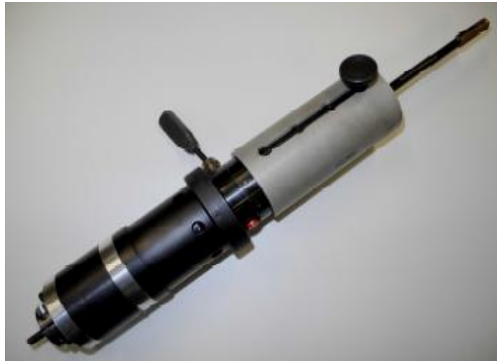
Obr. 4: Příklad přístroje pro roztlačování čelistí ve vývrtu (Kloiber a Drdácý, 2013)
