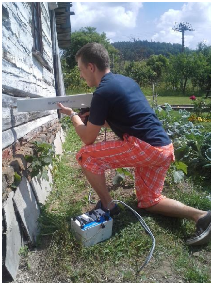
Obr. 16: Odporové vrtání přístrojem Resistograph 4453-P
