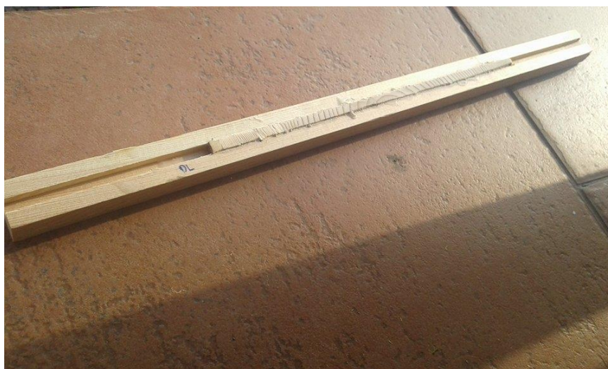
Obr. 19: Našlepené vývrty v dřevěných lištách
