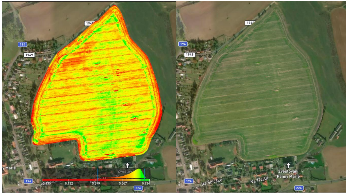
Obr. 6: Mapa z aplikace Pix4Dfields, vlevo vegetační index NDVI , vpravo ortofotomapa, pořízeno 27.3.2022
