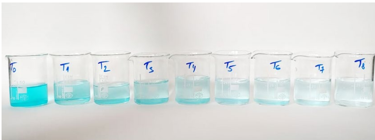
Obrázok 10 Postupné odfarbovanie vzoriek v závislosti na čase odberu z UV fotokatalytického reaktoru pri použití systému UV/H_2O_2
