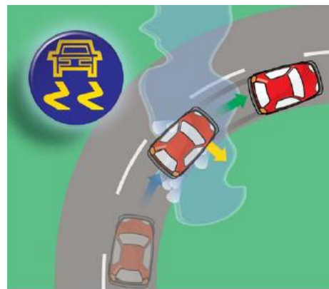
Obr. 35 Chování vozidla s funkcí ASR
