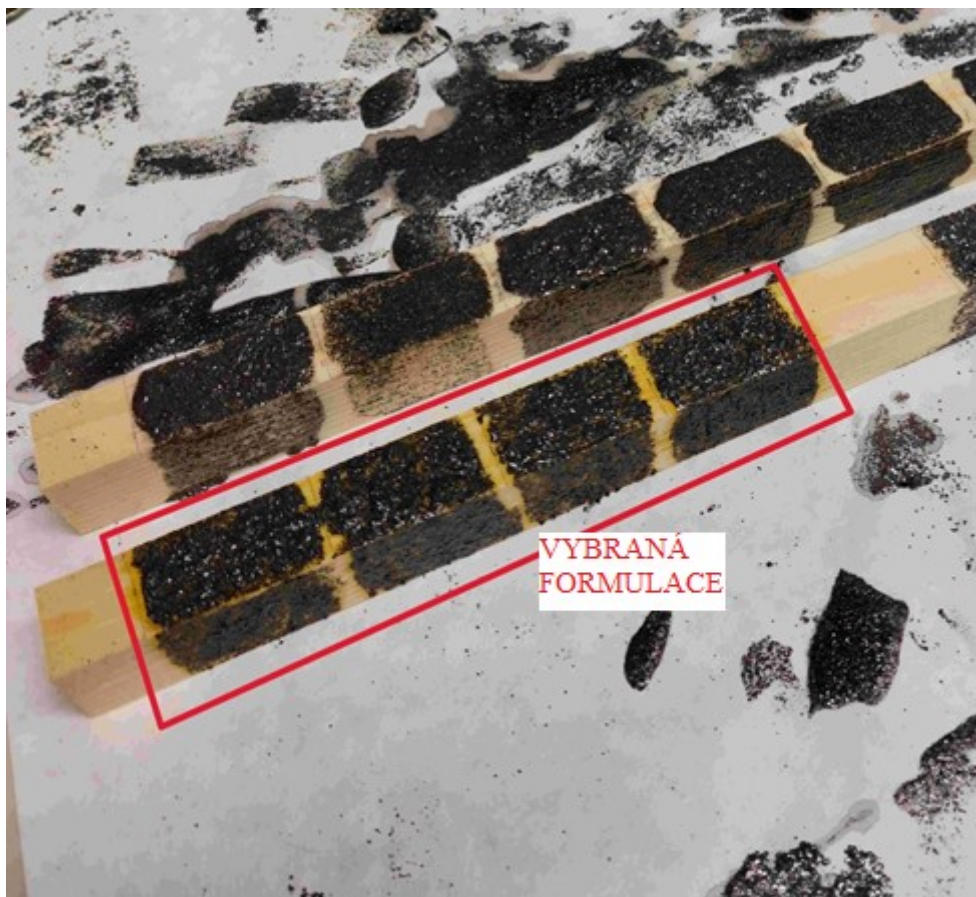
Obrázek 19. Testované formulace Termografit-Nanocelulóza (vybraná formulace druhá zprava).
