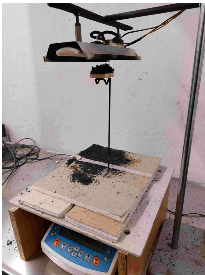
Obrázek 15. Testovací aparatura pro zkoušku sálavým tepelným zdrojem.
