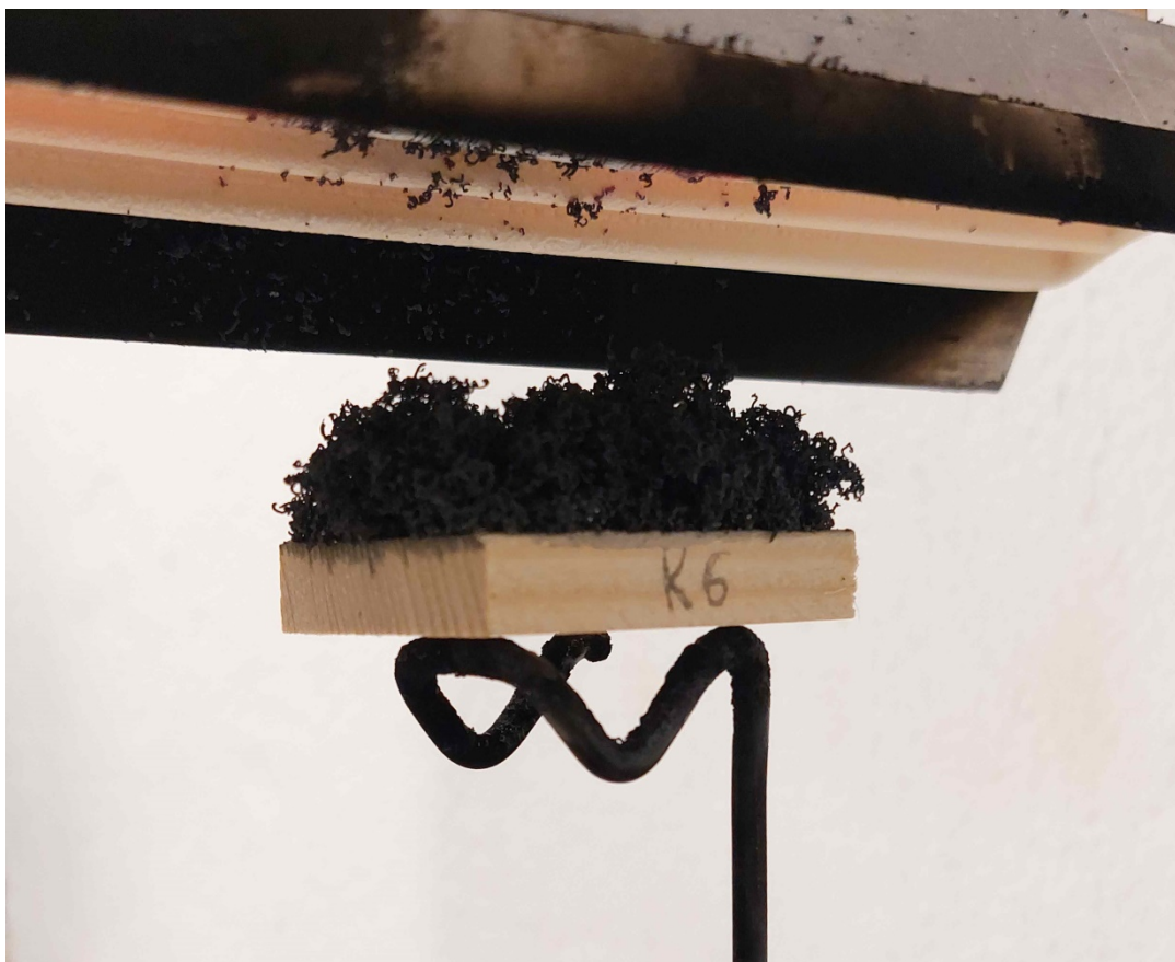
Obrázek 20. Expandovaný grafit ve formulaci s Klucelcem na vzorku smrkového dřeva po dosažení jeho startovací teploty.
