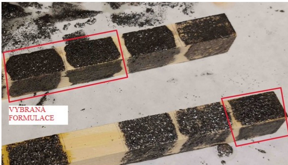
Obrázek 17. Testované formulace Termografit-Lovosa (vybraná formulace nahoře úplně vlevo).
