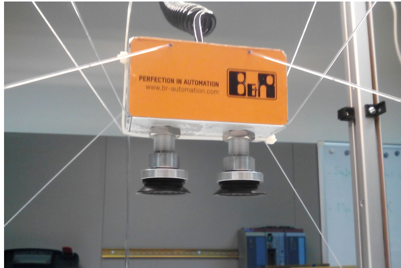
Obr. 2.2: Prísavky na platforme robota
