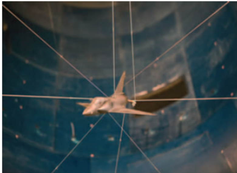
Obr. 1.15: Polohovanie objektu vo veternom tuneli SACSO [3]
