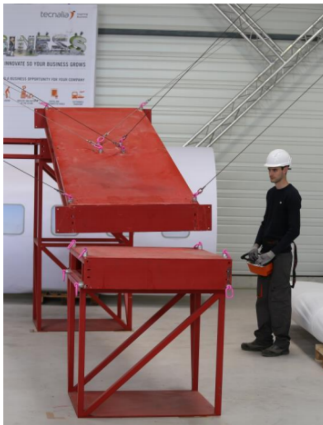
Obr. 1.5: Systém CoGiRo pre prenášanie objektov prepojením lán [5]
