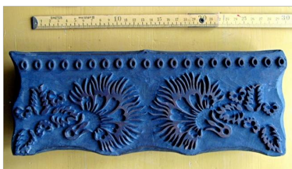
Obrázek 6: modrotisková forma z Kotíkovy dílny pro tisk tzv. rantlů
