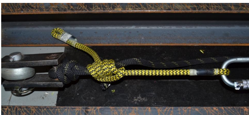
Příloha 12 – Blakeův uzel před působením síly – průměr lana 10 mm, lano průměr
