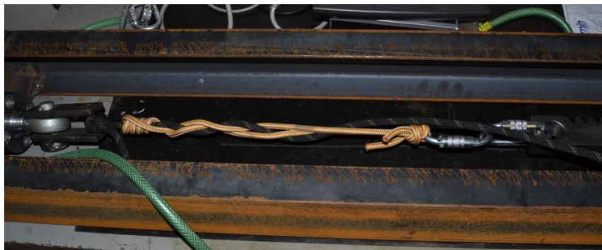
Příloha 1 – Francouzský prusík před působením síly - průměr prusíku 8 mm, průměr lana 10 mm
