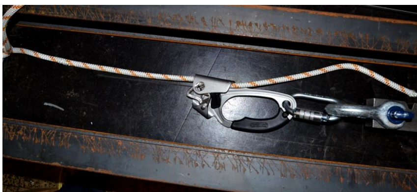
Příloha 18 – 1. měření ručním blokantem, došlo ke zlomení palce blokantu
