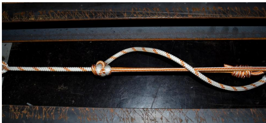
Příloha 7 – Klemheistův uzel po působení síly - průměr prusíku 8 mm, průměr lana
