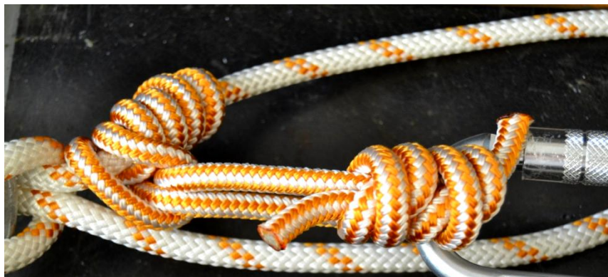
Příloha 6 – Klemheistův uzel před působením síly - průměr prusíku 8 mm, průměr lana 10 mm
