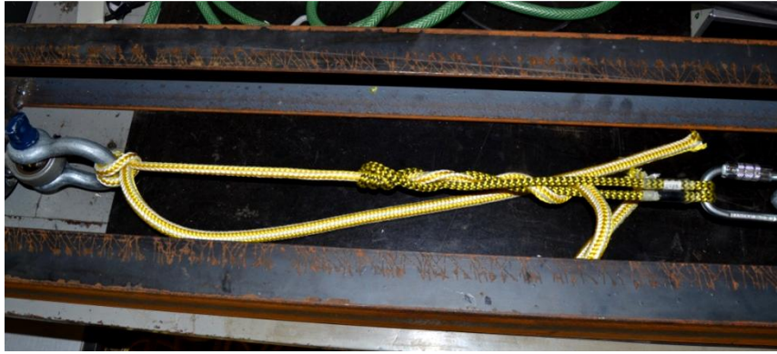
Příloha 4 – Francouzský prusík po působení síly - průměr prusíku 10 mm, průměr lana 13 mm
