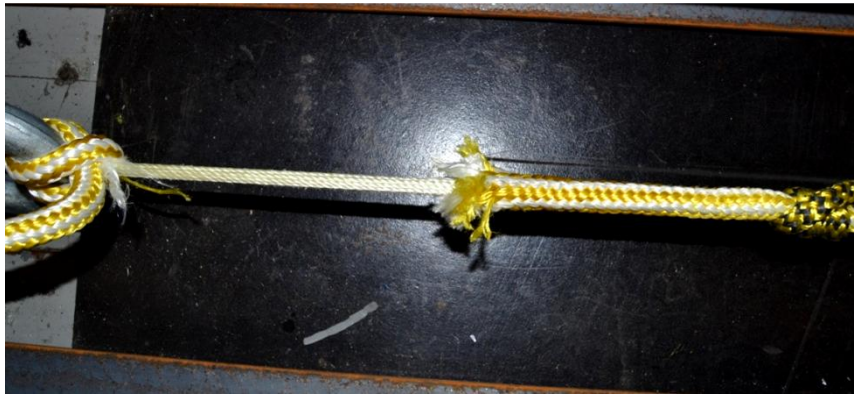
Příloha 5 – Lano o průměru 13 mm, přetržený oplet při měření francouzského prusíku
