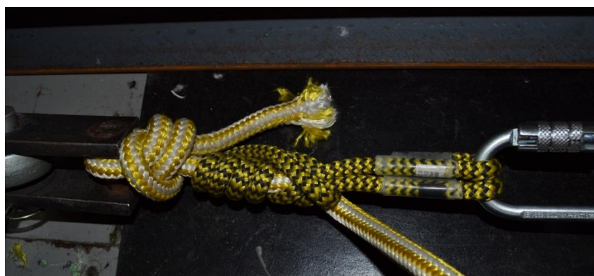
Příloha 8 – Klemheistův uzel před působením síly - průměr prusíku 10 mm, průměr lana
