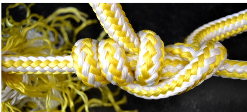
Příloha 11 – Blakeův uzel po působení síly – průměr lana 13 mm
