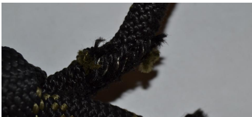
Příloha 15 – Lano po ukončení měření s Blakeovým uzlem - průměr 10 mm
