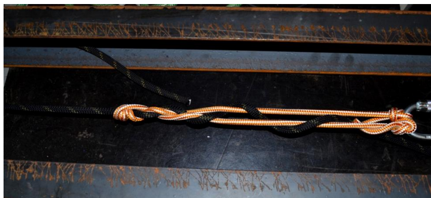
Příloha 2 – Francouzský prusík po působení síly - průměr prusíku 8 mm, průměr lana 10 mm
