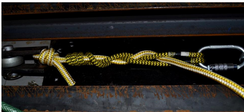
Příloha 3 – Francouzský prusík před působením síly - průměr prusíku 10 mm, průměr lana 13 mm
