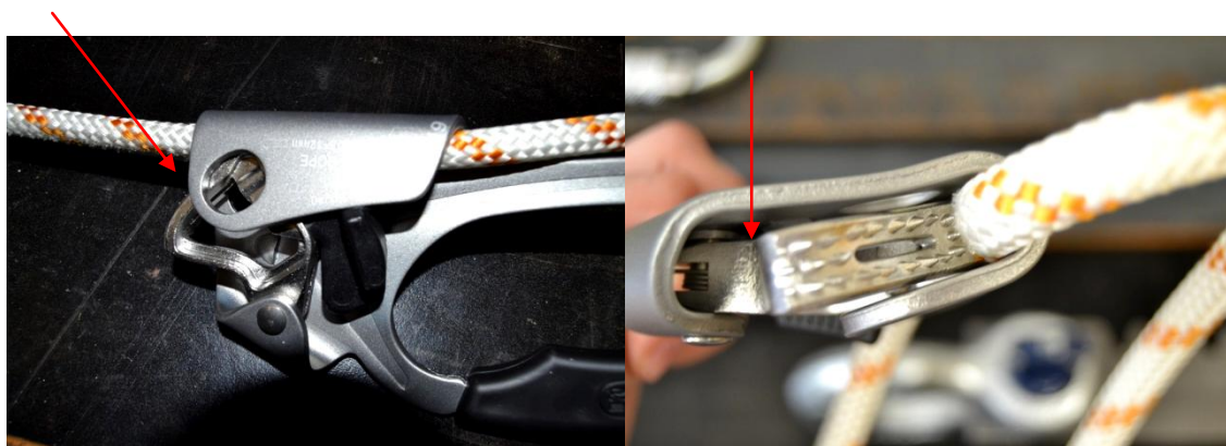
Obr. 22 – Poškozený ruční blokant – zlomený palec na blokantu
