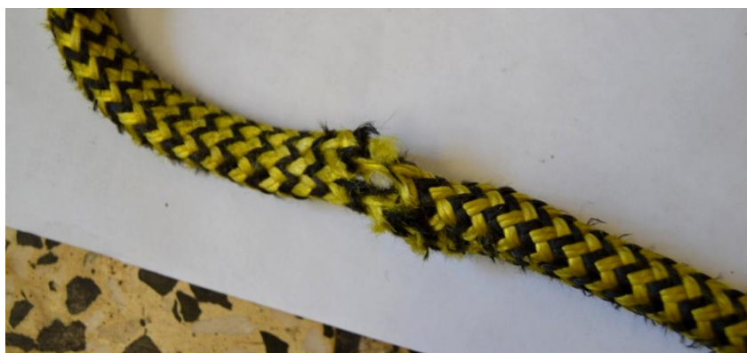
Příloha 14 – Prusík po ukončení měření s Blakeovým uzlem - průměr 10 mm
