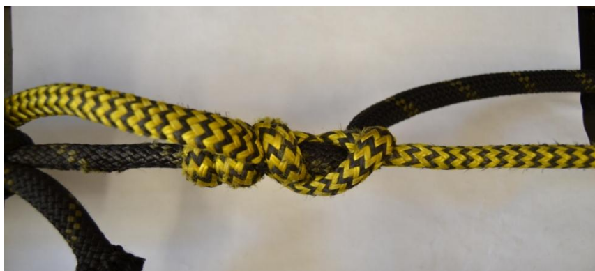
Příloha 13 – Blakeův uzel po působení síly – průměr lana 10 mm, lano průměr 10 mm
