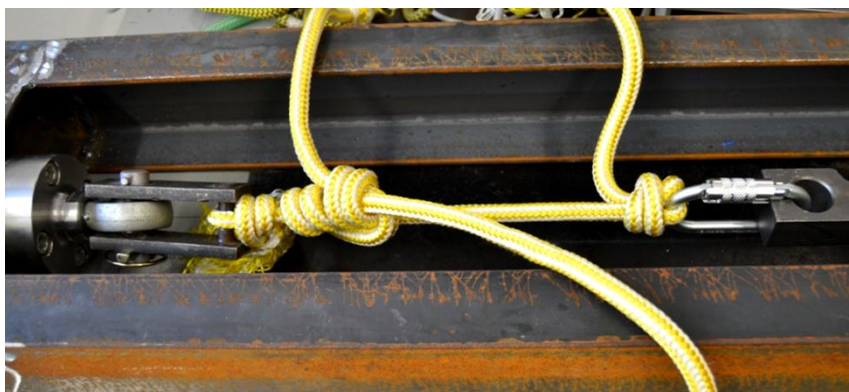
Příloha 10 – Blakeův uzel před působením síly – průměr lana 13 mm
