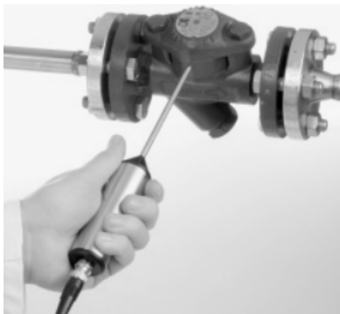
Obr. 21 Správné přiložení měřicí sondy na odvaděč kondenzátu
