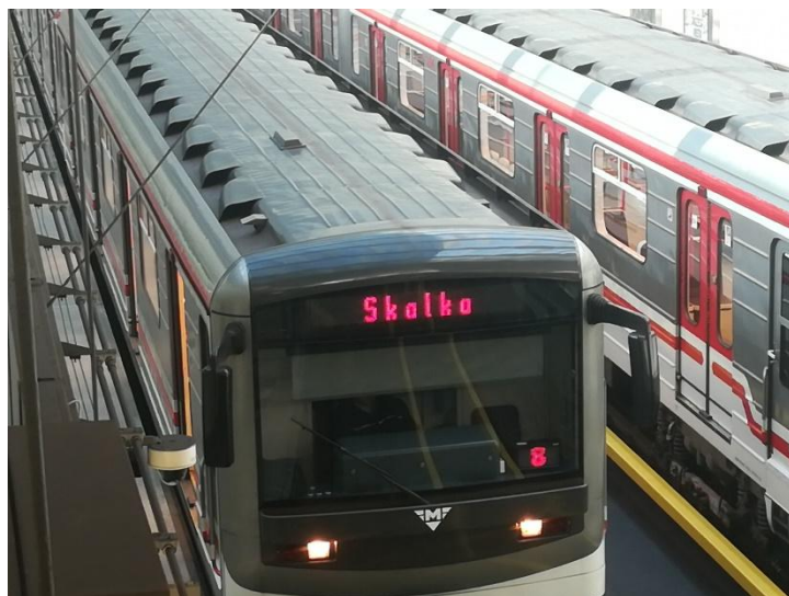
Obr. 12 - Průduchy náporové ventilace na střeše vozu 81-71M
