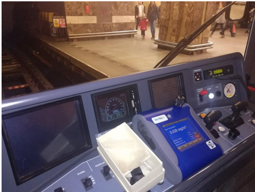
Obr. 19 - Měření v kabině – umístění přístroje na pultu strojvedoucího
