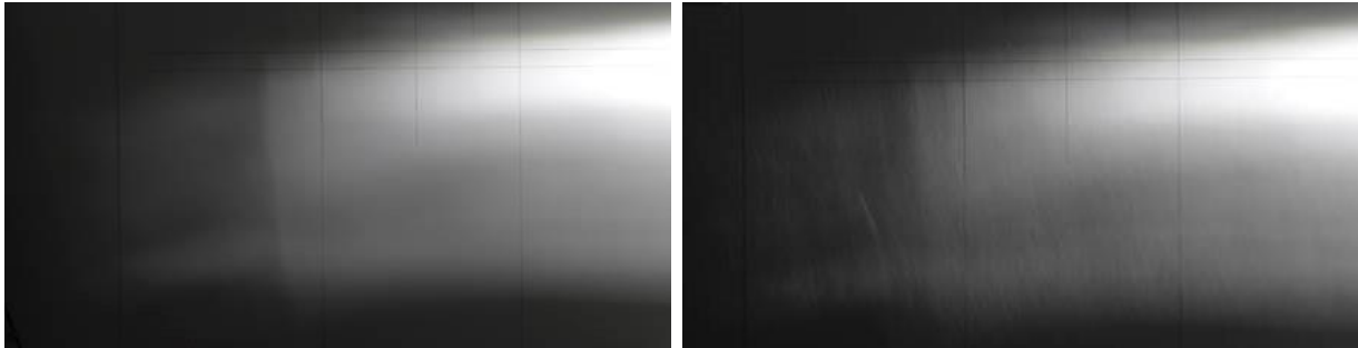
Obr. 96 Světelná stopa bez použití (vlevo) a s použitím (vpravo) krycího skla.
