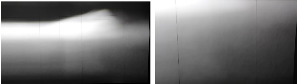
Obr. 97 Světelná stopa s použitím vadného krycí skla.
