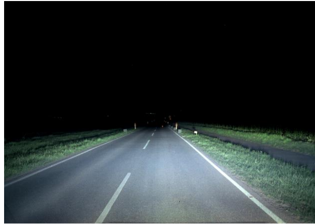
Obr. 8 Osvětlení vozovky xenonovou výbojkou [12].
