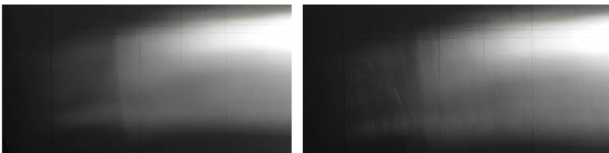
Obr. 63 Světelná stopa bez použití (vlevo) a s použitím (vpravo) krycího skla.
