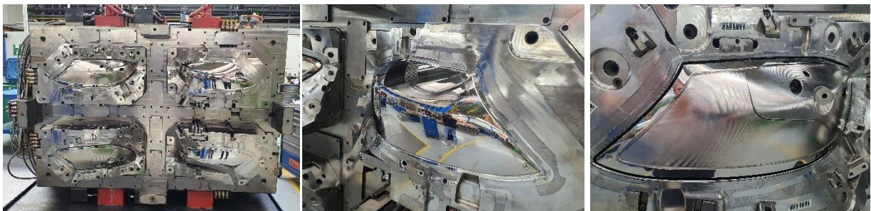
Obr. 95 Lisovací forma na výrobu krycího skla.
