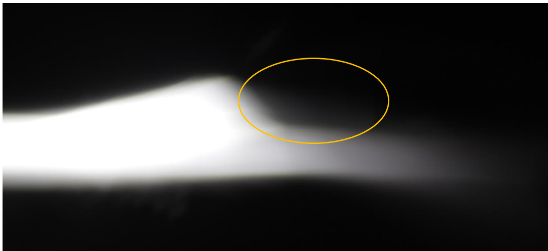
Obr. 59 Důsledek vady fazetky z Obr. 58 – parazitní odlesk, chybí ostrá hranice.
