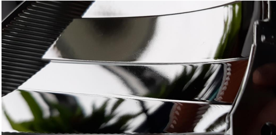
Obr. 85 Nedostatečně vyleštěné optické plochy.
