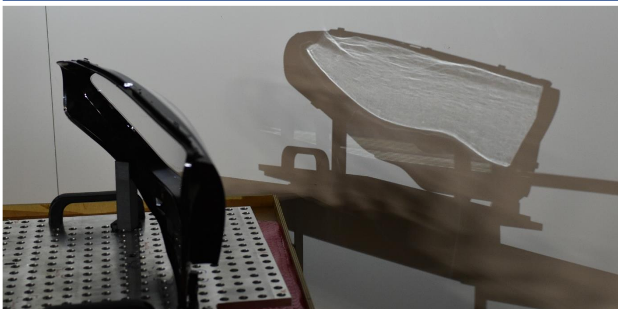
Obr. 88 Optická projekce nerovnosti povrchu.
