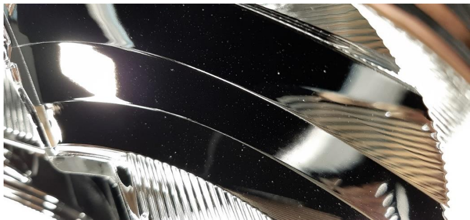
Obr. 86 Dostatečně vyleštěné optické plochy.
