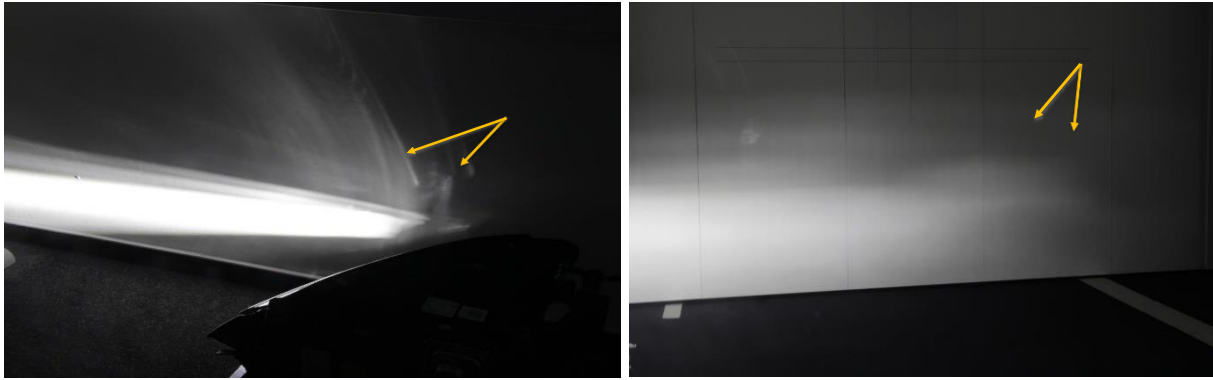
Obr. 71 Ukázka parazitních odlesků.
