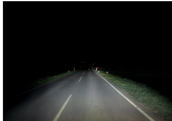
Obr. 6 Osvětlení vozovky žárovkou H4 [12].
