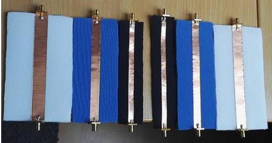
Obrázek 2.10 Vyrobene mikropáskové vedení – vlevo vedení LINE, vpravo vedení THRU
