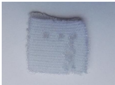
Obrázek 5.1 3D-textil s vysekanými otvory pro prokovy a s narušenou strukturou
