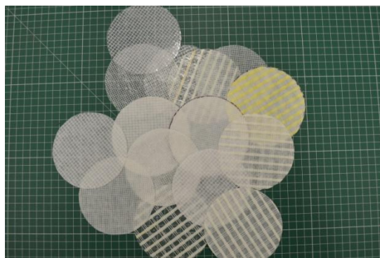
Příloha 5: Fotografie zobrazující kruhové vzorky sklovláknitých mřížek připravených pro měření v impedanční trubici..
