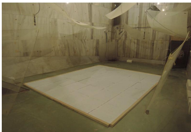
Příloha 3: Fotografie z dozvukové místnosti zobrazující akustické panely založené na pěnové hmotě Cello HR 290/0.
