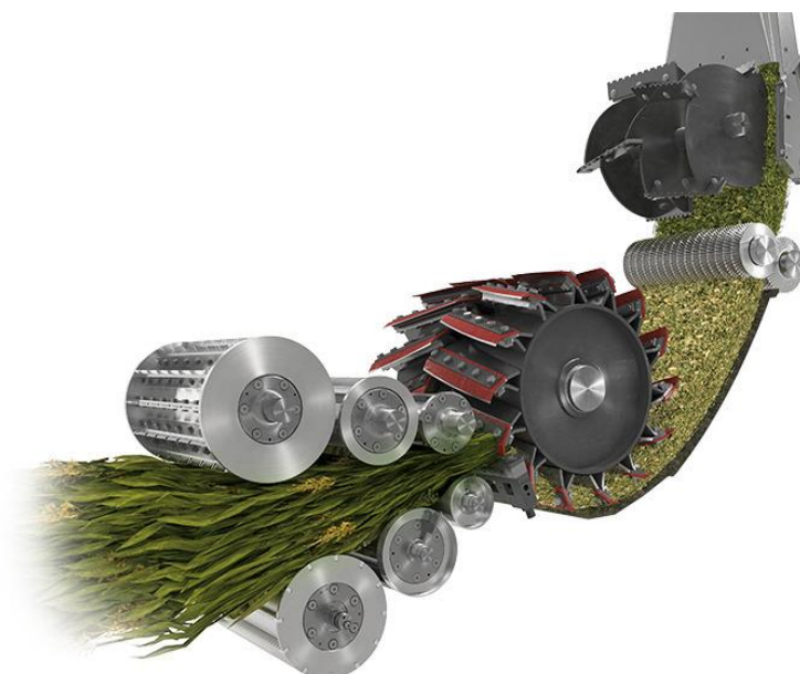
Obr. 11.: Vkládací ústrojí, řezací ústrojí, UNI CRECKER, metač Dopravní prostředky
