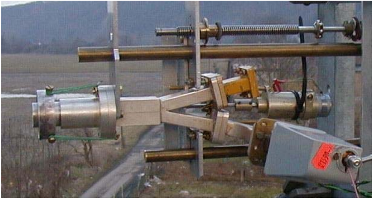
Obr. 7.2: Buzení ozařovače pomocí vlnovodů (převzato z osobního archivu Zdeňka Samka).
