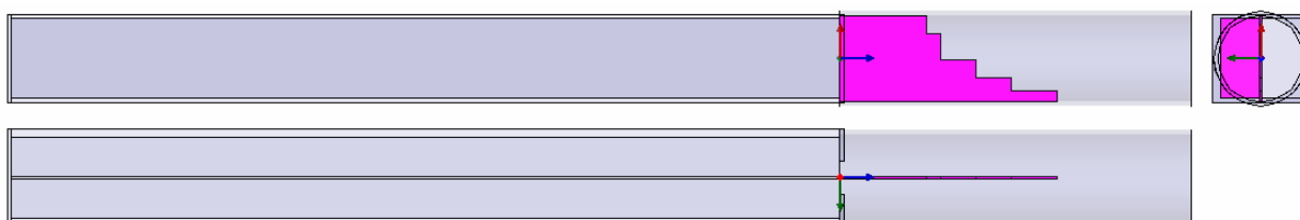
Obr. 11.9: Ozařovač kruhového průřezu s napojenými vlnovody R120.
