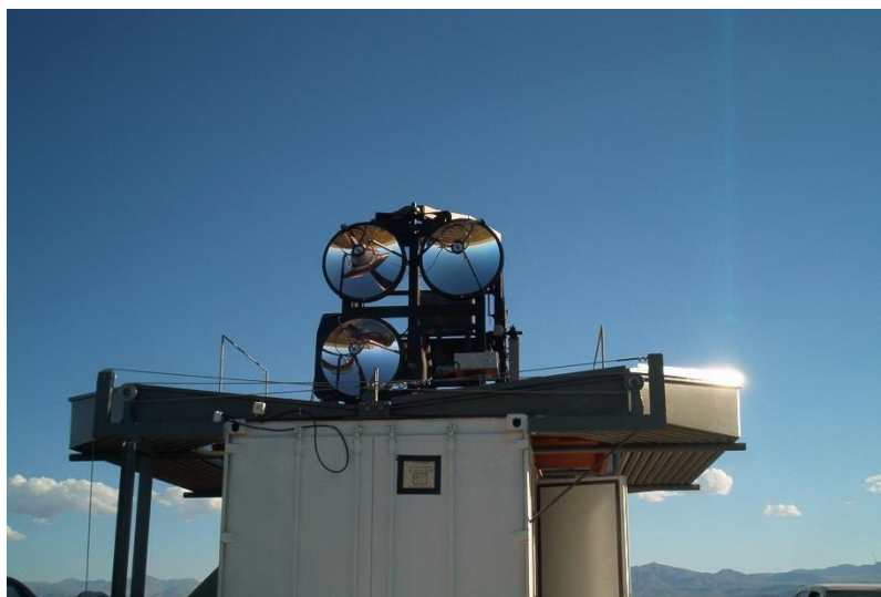
Obr. 10: Elastický lidar (Převzato z [7]).
