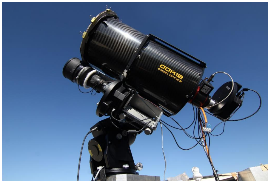
Obr. 14: Robotický teleskop FRAM s širokoúhlým polem dole a úzkým polem nahoře (Převzato z [3]).
