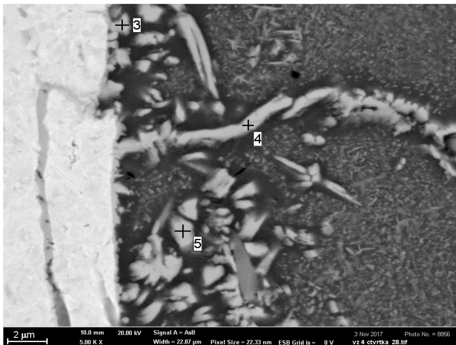
Obr. 3.22 - Detail rozhraní svar/WL10 po žihání na 800 °C/1h s Ni (REM; 5K×)
