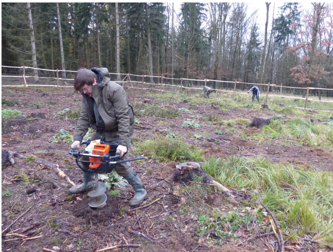
Příloha 5 – hloubení výsadbové jamky pomocí motorového jamkovače Stihl BT 121, Koží Hory II
