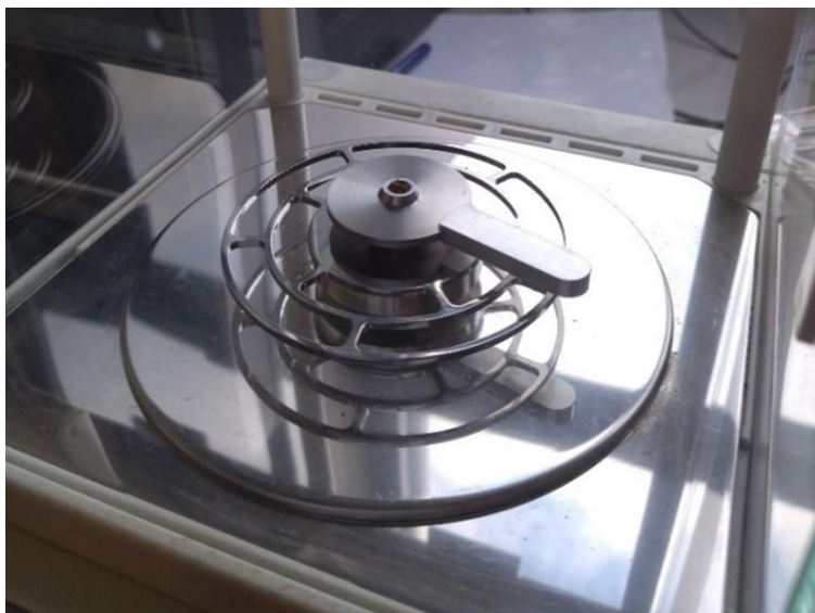
Obrázek 4- Navážený vzorek vložený do hliníkové pánvičky. HÁJKOVÁ (2021)
