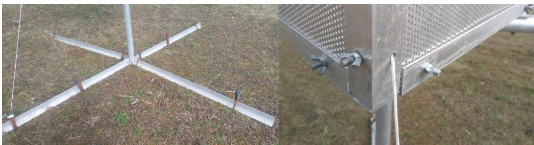
Obrázek 11: Ukotvení odražeče k zemi a upevnění desek odražeče
