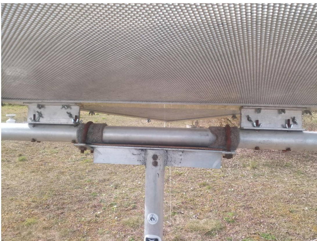
Obrázek 12: Upevnění odražeče k nosné konstrukci
