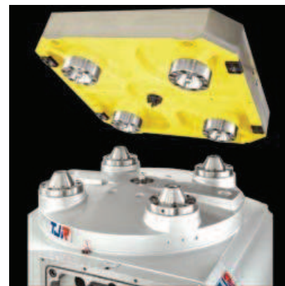
Obr. 31 Systém zpevnění a polohování šroub – kuželový čep (TJR) [32]
