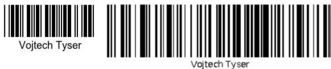
Obr. 1.6 Příklady lineárních čárových kódů
