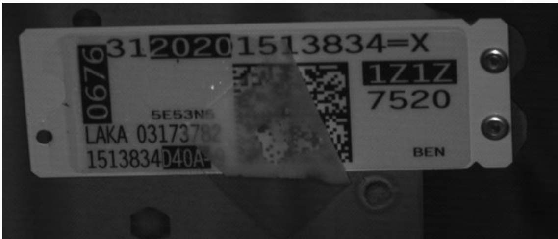
Obr. 3.3 Odlepená ochranná fólie TPS štítku
