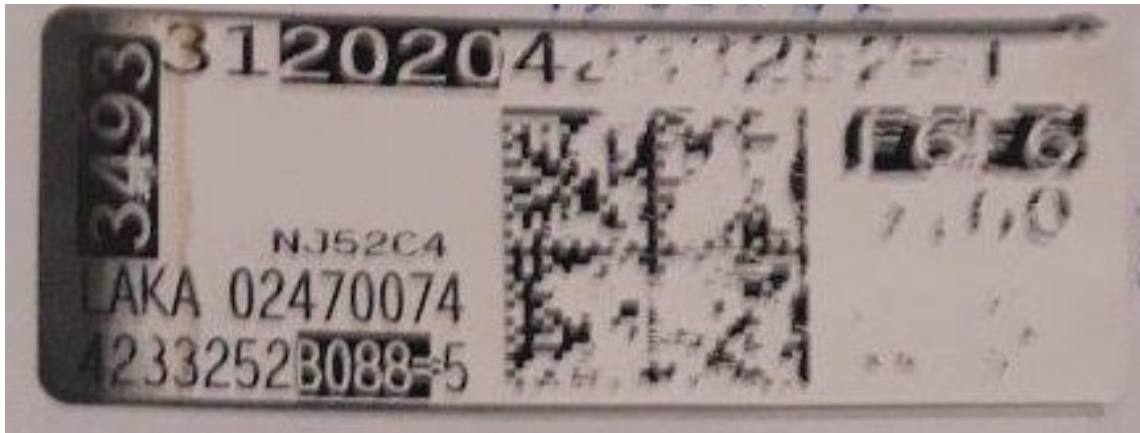
Obr. 3.4 Mechanické poškození dat TPS štítku
