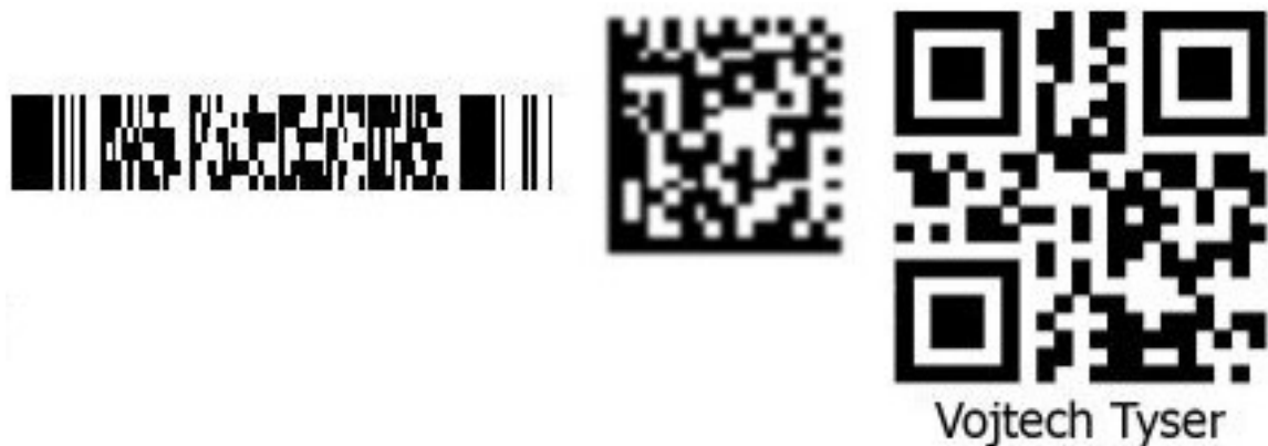
Obr. 1.7 Příklady dvoudimenzionálních kódů
