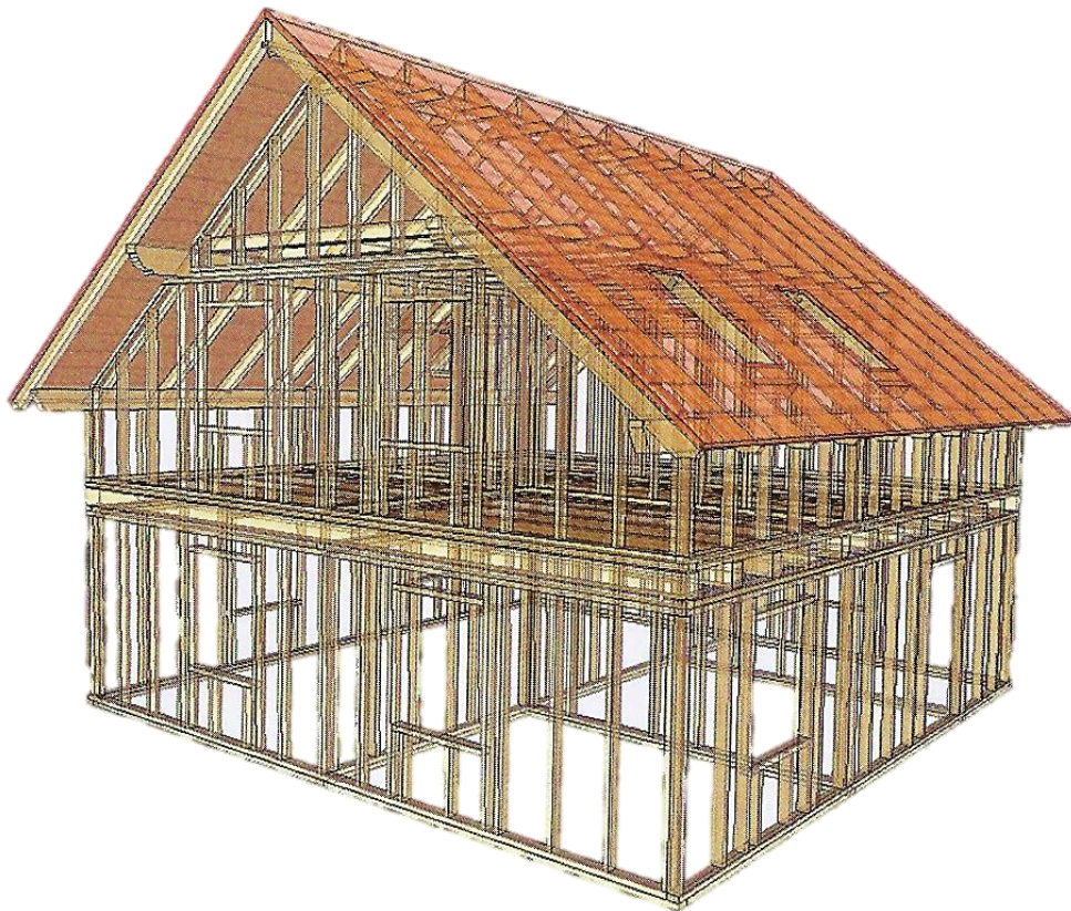
Obr. 1 Schéma rámové dřevostavby (Štefko, Reinprecht, Kuklík 2009)
