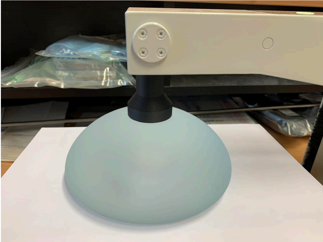
Obr. 26 Měření – přiložení indentoru na vrch implantátu (zdroj: autor)
